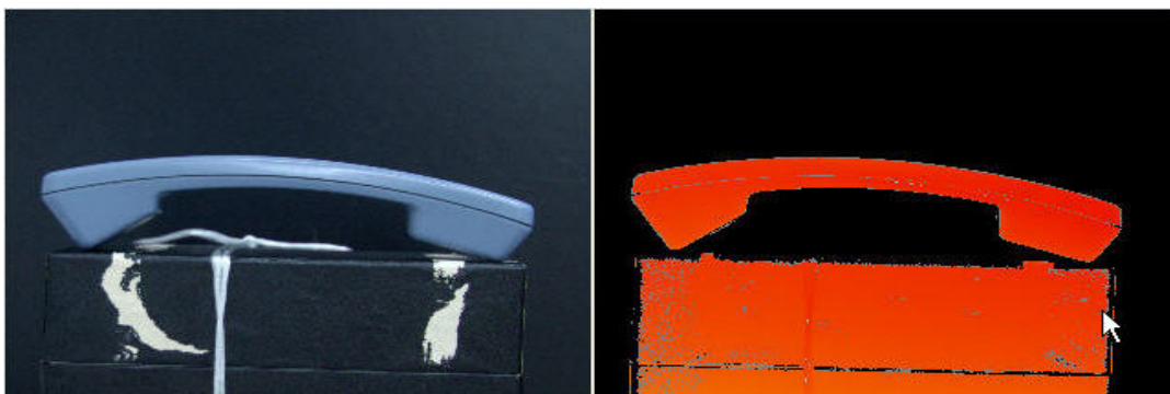
ΕΙΚΟΝΑ 4.4: ΨΗΦΙΟΠΟΙΗΣΗ ΤΗΣ FRONT SIDE ΜΕ ΧΡΗΣΗ AUTO FOCUS (ΕΣΤΙΑΚΗ ΑΠΟΣΤΑΣΗ = 800 mm ΚΑΙ LD = 10).
