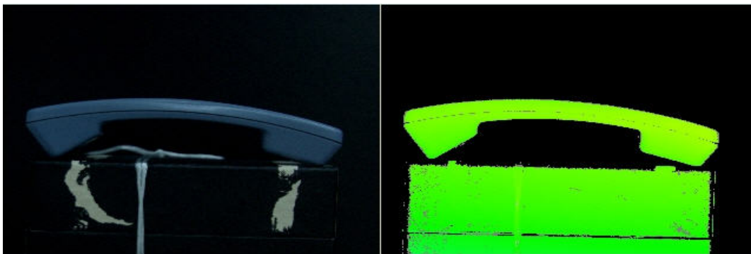
ΕΙΚΟΝΑ 4.5: ΝΕΑ ΨΗΦΙΟΠΟΙΗΣΗ ΜΕ ΕΣΤΙΑΚΗ ΑΠΟΣΤΑΣΗ ΣΤΑ 750 mm ΚΑΙ LD = 10.
