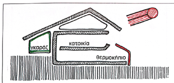
Εικόνα3.3.2 Τομή βιοκλιματικού κελύφους
