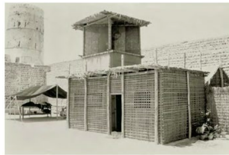
Εικόνα2.3.15 Ανεμοσυλλέκτης (barjeel) σε μια κατοικία (“arish”) από φοινικόφυλλα στην Αραβική χερσόνησο, αποτελεί μια ευφυή, πανάρχαια τεχνολογία παθητικού δροσισμού, σχεδιασμένη για το κλίμα της ερήμου.
