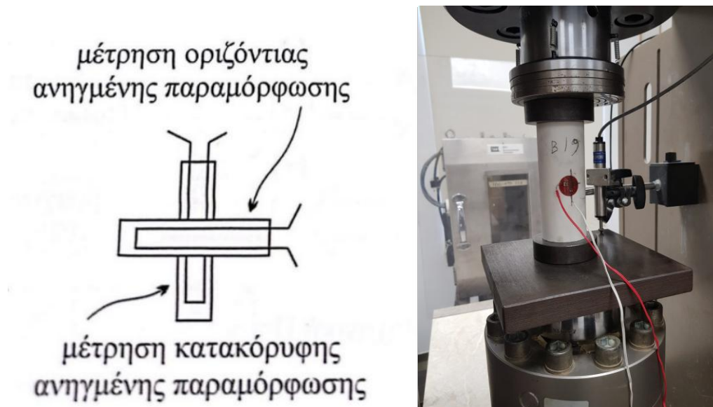
Σχήμα 3.11: Τοποθέτηση ηλεκτρικών μηχανοσυστημάτων τύπου σταυρού (δύο κάθετα) στο δοκίμιο μαρμάρου (Αγιουτάντης, 2019).
