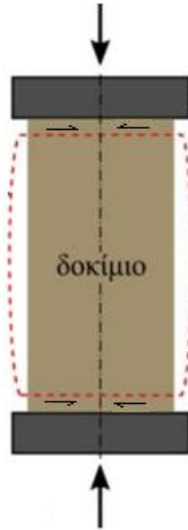
Σχήμα 2.7: Παραμόρφωση δοκιμίου σε μορφή βαρελιού.
