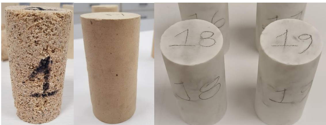
Σχήμα 3.5: Τελικά δοκίμια πριν την δοκιμή μονοαξονικής θλίψης. Από τα αριστερά προς τα δεξιά απεικονίζονται: ο ψαμμίτης, ο μαλακός ασβεστόλιθος Lecce και τα μάρμαρα τύπου Α.
