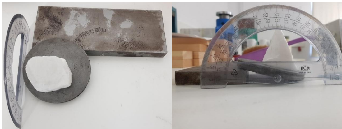
Σχήμα 3.12: Υπολογισμός τριβής με χαλύβδινη πλάκα και μοιρογνώμονιο.
