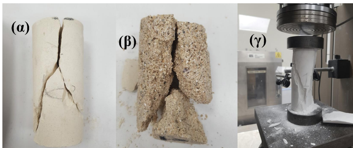
Σχήμα 4.4: (α) υοειδή θραύση πετρώματος Lecce (Y-shaped failure), (β) υοειδή θραύση πετρώματος Φαμμίτη (Y-shaped failure), (γ) Αξονική κατάτμηση μαρμάρου B (Axial splitting).
