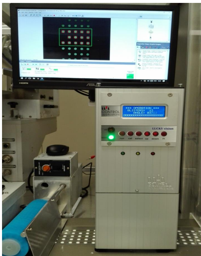
Εικόνα 5. Πειραματική Διάταξη Ελέγχου με Σύστημα Μηχανικής Όρασης (Πηγή: Ιδία λήψη)
