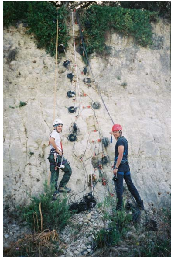
Εικόνα 6.17. Η πλευρά του πρανούς στην οποία τοποθετήθηκαν τα γεώφωνα των P και S κυμάτων.
