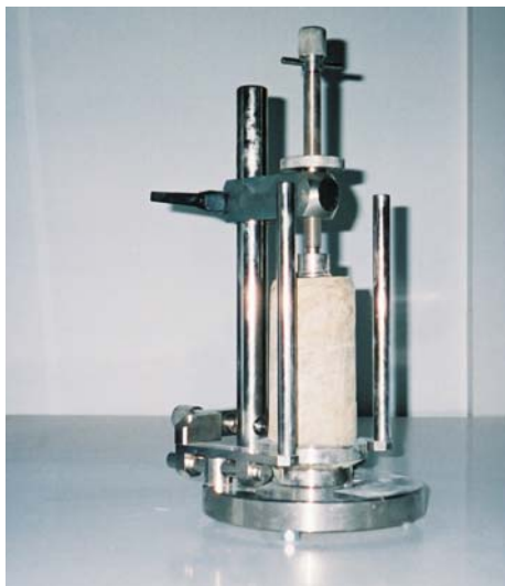
Εικόνα 7.4. Διαμορφωτής κυλινδρικών εδαφικών δοκιμίων.
