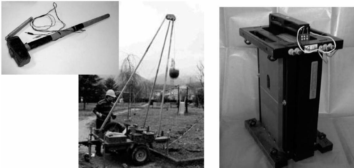
Εικόνα 3.1. Τύποι πηγών σεισμικής ενέργειας. Κατά σειρά παρουσιάζονται : Σφυρί, πίπτον βάρος, συσκευή μηχανικής δόνησης του εδάφους.
