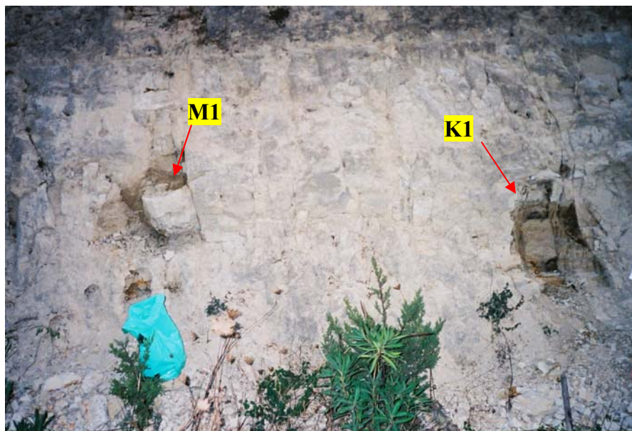
Εικόνα 7.1. Φωτογραφία από την δειγματοληψία στο πρυνές των γεωφυσικών διασκοπήσεων. Το δείγμα M1 δεν έχει ακόμα απομονωθεί ενώ το K1 έχει ήδη αποκομιστεί.
