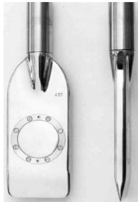
Εικόνα 4.3. Η λεπίδα του επίπεδου ντιλατομέτρου. Διακρίνεται η μεταλλική μεμβράνη (Marchetti, 1980) .
