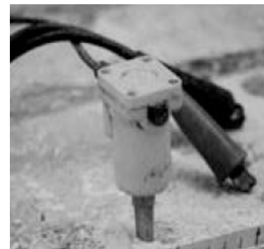
Εικόνα 6.3. Γεωφώνο καταγραφής σεισμικών κυμάτων (Foti, 2003). Το είδος του διακρίνεται σε κατακόρυφης συνιστώσας για την καταγραφή των P κυμάτων και οριζόντιας για την καταγραφή των κυμάτων S.
