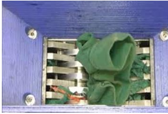
ΕΙΚΟΝΑ 3 : Δίσκοι με λεπίδες όπου περνά το ρούχο και τεμαχίζεται σε μικρά κομμάτια. (Σταμέλος, 2019)
