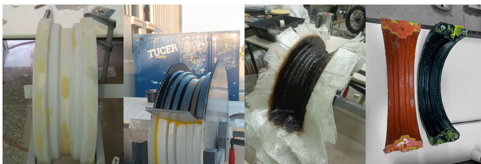
Σχήμα 6.3: Στάδια κατασκευής μήτρας στεφανιού
