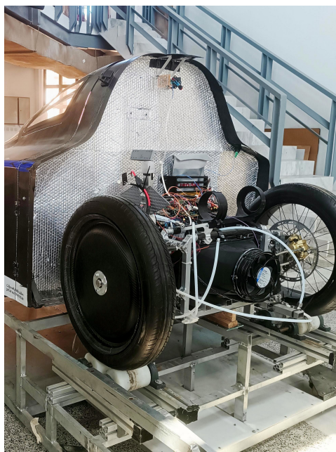
Σχήμα 7.8: Νέος και παλιός τροχός στο όχημα
