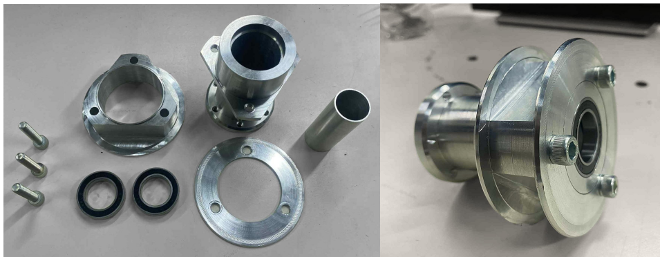
Σχήμα 6.7: Εξαρτήματα και συναρμολόγηση κέντρου
