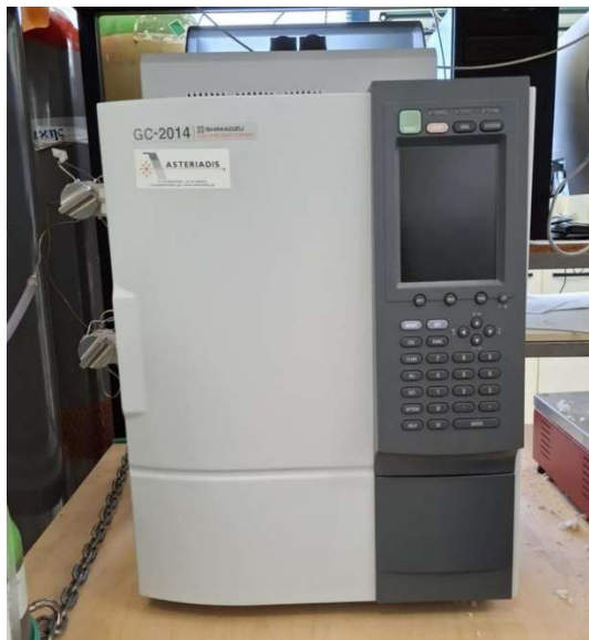
Εικόνες 2 και 3: Αριστερά φαίνεται ο ηλεκτρικός φούρνος και δεξιά ο αέριος χρωματογράφος (GC-2014, Shimadzu).
