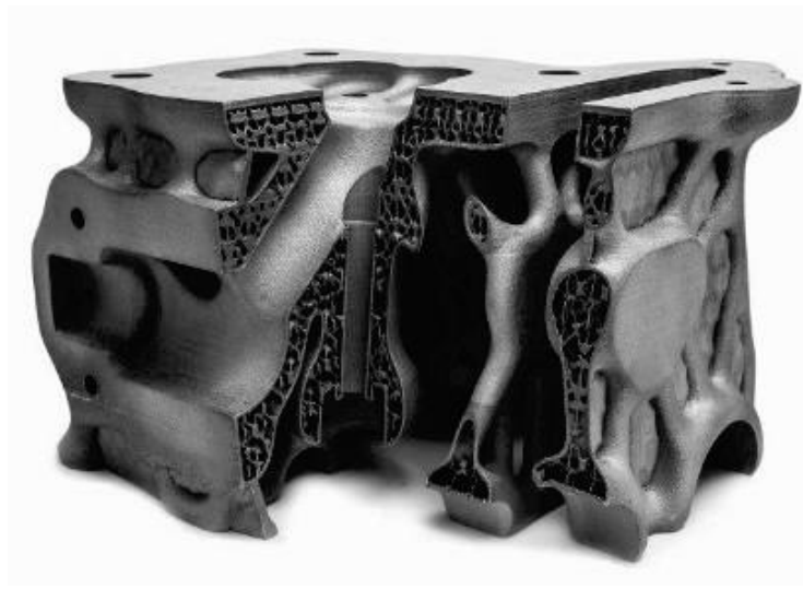
Σχήμα 3.21: Κυλινδροκεφαλή με εσωτερικές πλεγματικές δομές. Ο νέος σχεδιασμός προκαλεί μείωση του βάρους κατά 66%, ενώ με την αύξηση του εμβαδού η ψύξη είναι αποτελεσματικότερη [26].
