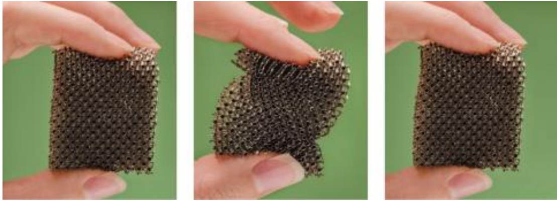
Σχήμα 3.25: Μεταλλικό μικροπλέγμα με αντιστρεπτή παραμόρφωση και αυξητική συμπεριφορά [24]
