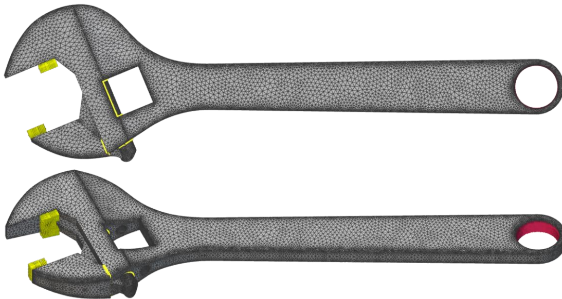
Σχήμα 4.10: Μοντέλο πεπερασμένων στοιχείων (FE Model) και οριακές συνθήκες (Boundary Conditions). Η θέση και η κατεύθυνση κάθε επιβαλλόμενης δύναμης στις σιαγόνες φαίνεται με κίτρινο χρώμα. Η πάκτωση απεικονίζεται με κόκκινο χρώμα. Με ανοιχτό κίτρινο χρώμα παρουσιάζονται οι συνδέσεις των πλεγμάτων των δύο σωμάτων.
