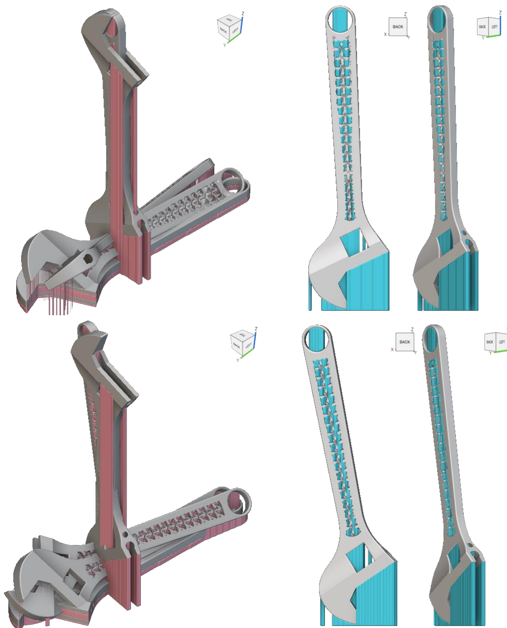
Σχήμα 4.33: Προσανατολισμοί και όγκοι των υποστηρικτικών δομών (αριστερά) της σταθερής σιαγόνας – λαβής του γαλλικού κλειδιού και η βέλτιστη επιλογή τους (δεξιά) για τις περιπτώσεις σχεδιασμών χωρίς (πάνω) και με τη χρήση του περιορισμού των προεξοχών (κάτω)
