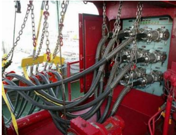
Εικόνα 4.10: Σύστημα σύνδεσης καλωδίων πάνω στο πλοίο [70].
