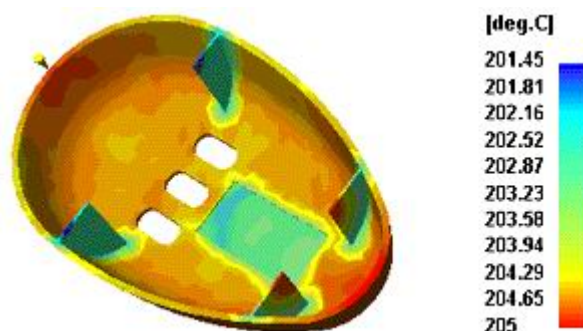
Εικόνα 3.16... Χρωματική αναπαράσταση θερμοκρασιών μετώπου ροής
