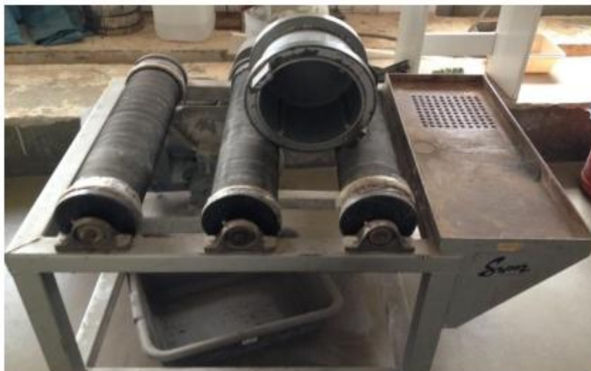
Εικόνα 3.2: Εργαστηριακός Σφαιρόμυλος με το σύστημα περιστροφής
