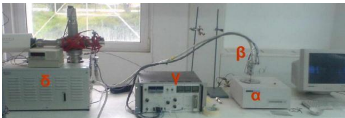
Εικόνα 3.7: Σύνδεση θερμοζυγού και φασματογράφου μάζας (TG – MS). Στο σχήμα διακρίνονται: α) ο θερμοζυγός, β) ο σύνδεσμος μεταφοράς των αερίων, γ) η συσκευή θέρμανσης της τριχοειδούς στήλης και δ) ο φασματογράφος μάζας.
