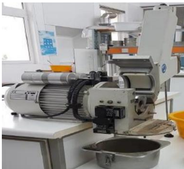
Εικόνα 3.1: Μαχαιρόμυλος τύπου Pulverisette 15, της εταιρείας Fritsch
