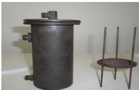
Εικόνα 3.5: Πυρολυτής Σταθερής Κλίνης
