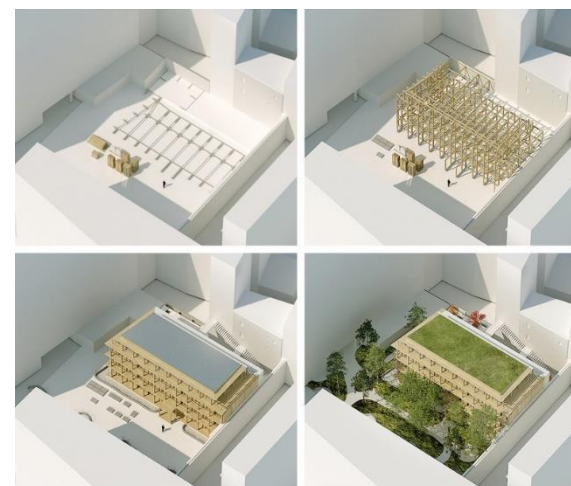
Εικόνα 75 : Στάδια κατασκευής κτηρίου
