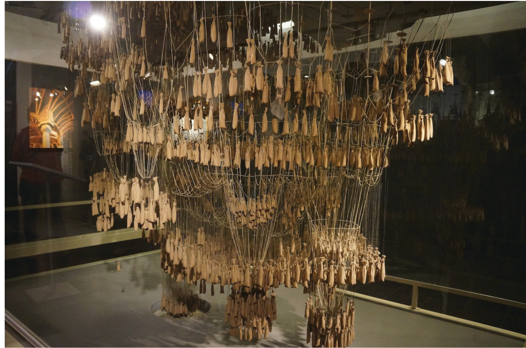
Εικ. 21 : Μοντέλο μελέτης του γκαουντί με κρεμασμένα σχοινιά και βάρη, Βαρκελώνη
