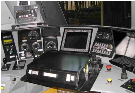
Εικόνα 2.2: Εποχούμενος εξοπλισμός ECTS : Διεπαφή Μηχανοδηγού και Μηχανημάτων (Πηγή : Ευρωπαϊκό Ελεγκτικό Συνέδριο 2017)
