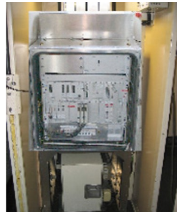
Εικόνα 2.2: Εποχούμενος εξοπλισμός ECTS : Διεπαφή Μηχανοδηγού και Μηχανημάτων (Πηγή : Ευρωπαϊκό Ελεγκτικό Συνέδριο 2017)
