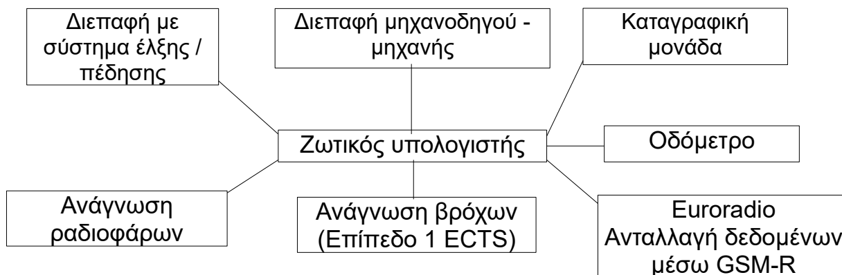
Σχήμα 2.1: Σύνδεση εποχούμενου εξοπλισμού με το σύστημα ασύρματο δίκτυο επικοινωνιών και μετάδοσης δεδομένων (GSM-R) (Πηγή : Χατζηκωσταντίνου 2018)
