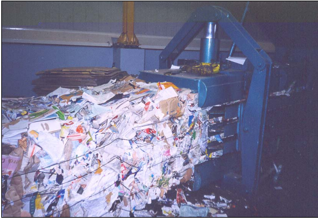
Εικόνα 5.5 Συμπιεστής - Δεματοποιητής υλικών
