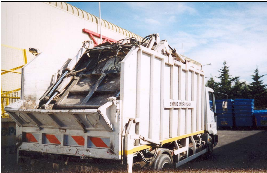
Εικόνα 4.5 Απορριμματοφόρο όχημα χαμηλής συμπίεσης, όπου είναι εμφανής ο μηχανισμός τύπου ‘πρέσας’
