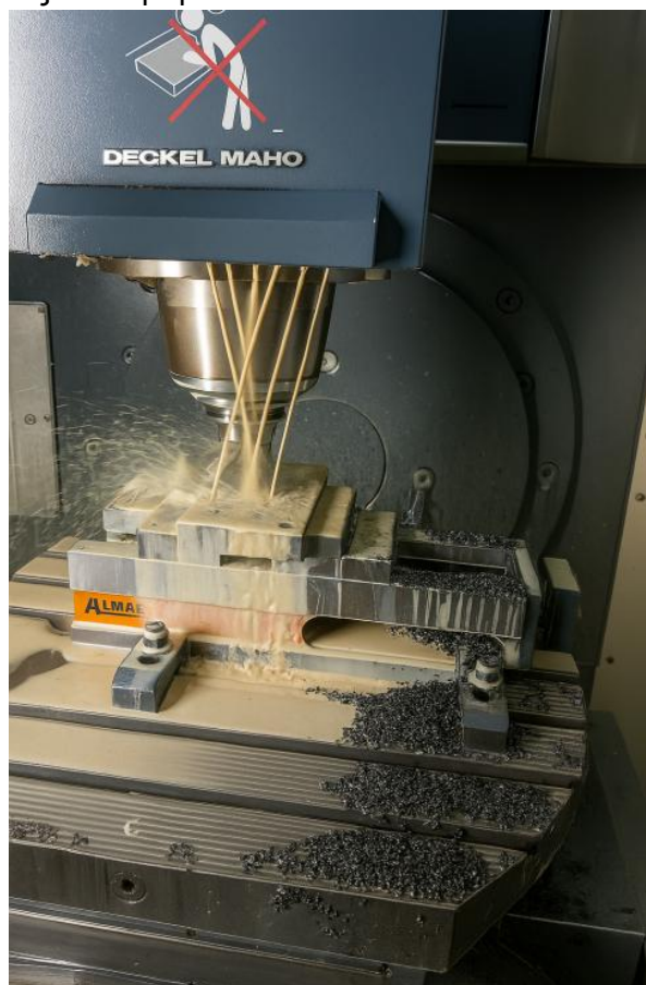
Εικόνα 18: Εκχόνδριση του τεμαχίου στην φραιζα
