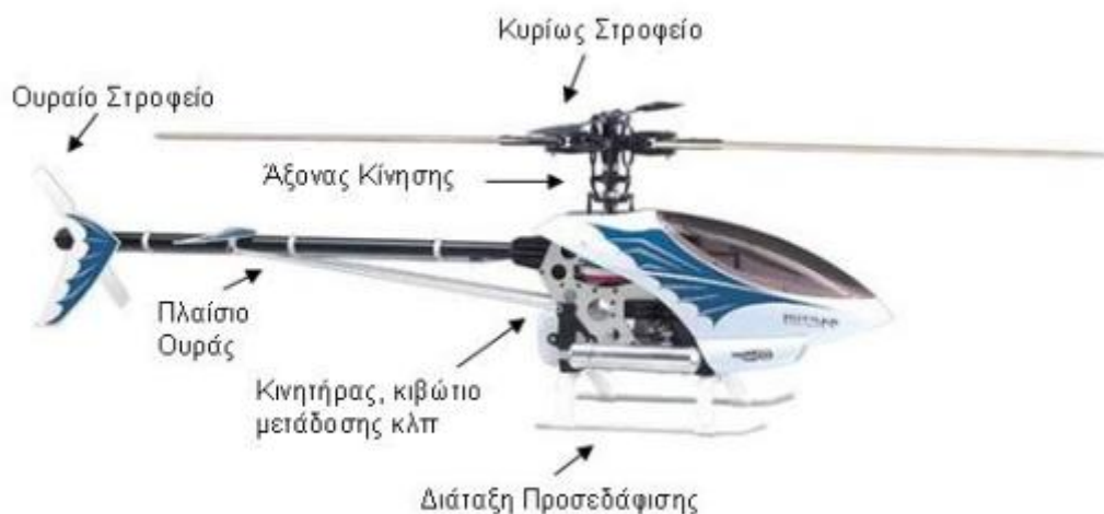
Εικόνα 4.2 Στοιχειώδη τμήματα μη επανδρωμένου ελικοπτερου [27].
