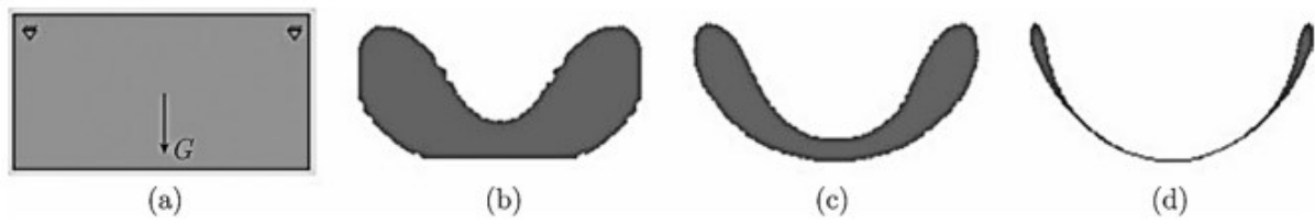
Εικόνα 10 - ESO Method - Επαναληπτική διαδικασία αφαίρεσης υλικού [11]
