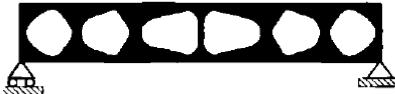
Εικόνα 6 - Τοπολογική βελτιστοποίηση δισδιάστατης γεωμετρίας [7]
