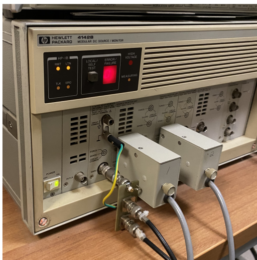
FIGURE 5.1: Το μετρητικό DC HP4142 modular SMU του εργαστηρίου μικροηλεκτρονικής του Πολυτεχνείου Κρήτης.
