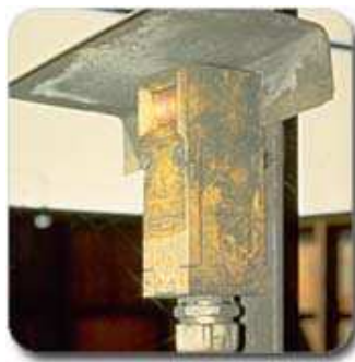
Εικόνα 7.6: Αισθητήρας γεμάτος σκόνη [23]
