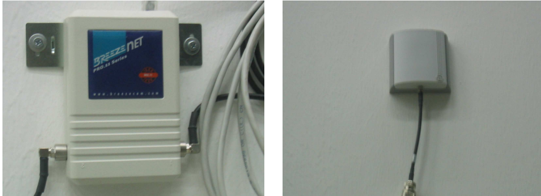
Εικόνα 6.1: α) Κεντρική συσκευή του ασύρματου κιτ, β) Κεραία του ασύρματου κιτ
