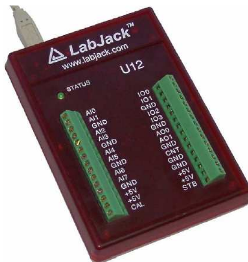
Εικόνα 2.11: Η κάρτα U12 της Labjack Co. [7]
