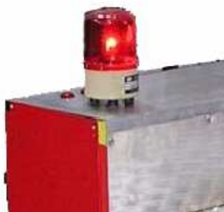
Εικόνα 2.15: Η τοποθέτηση του φάρου πάνω στη πλατφόρμα
