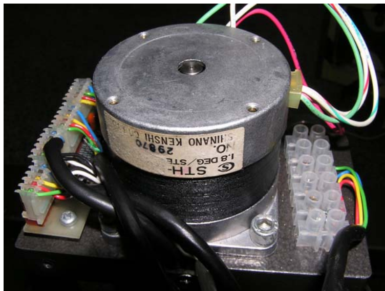
Εικόνα 3-1: Βηματικός κινητήρας του ρομπότ TALOS
