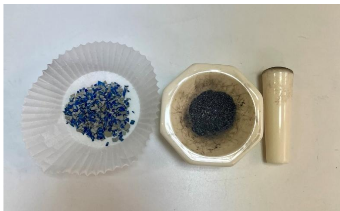
Εικόνα 3.6.1.ι: Λειοτρίβηση δείγματος πάνελ.
