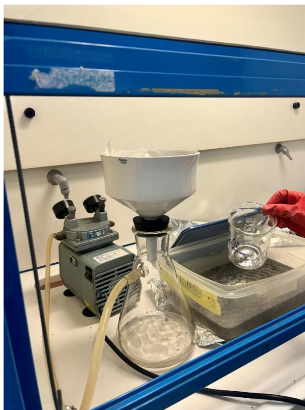
Εικόνα 3.4.1: Διήθηση του μείγματος για τον διαχωρισμό υγρού-στερεών.
