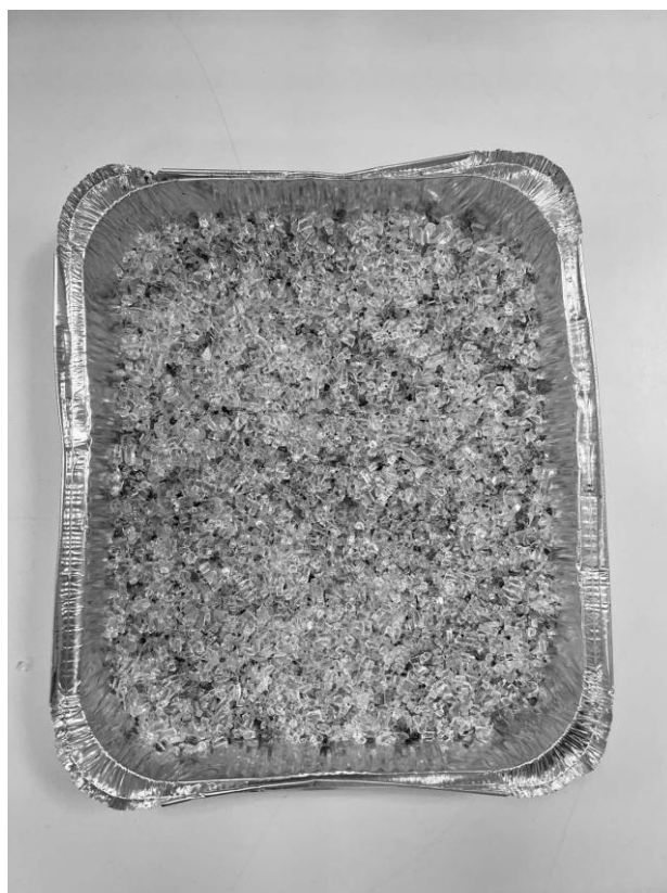
Εικόνα 3.4.2: Τα στερεά (πάνελ & γυαλί) μετά την εξάτμιση του τολουενίου.
