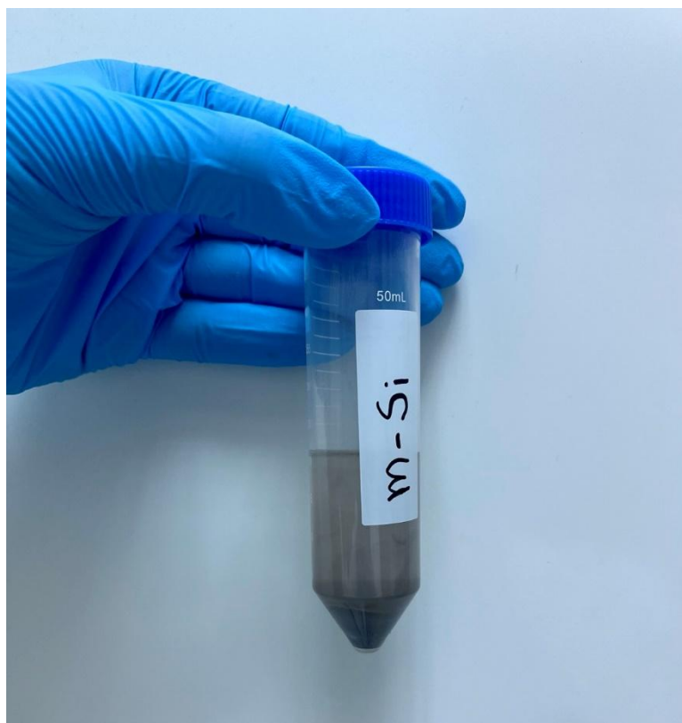
Εικόνα 3.6.1.iv: Διαχωρισμένο μείγμα έπειτα της φυγοκέντρησης.
