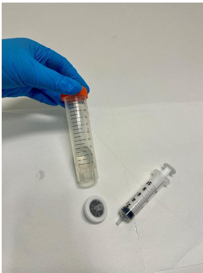
Εικόνα 3.6.2. ν: Διηθημένο δείγμα 5mL, μέσω φίλτρου μεμβράνης nylon 0,45μm.
