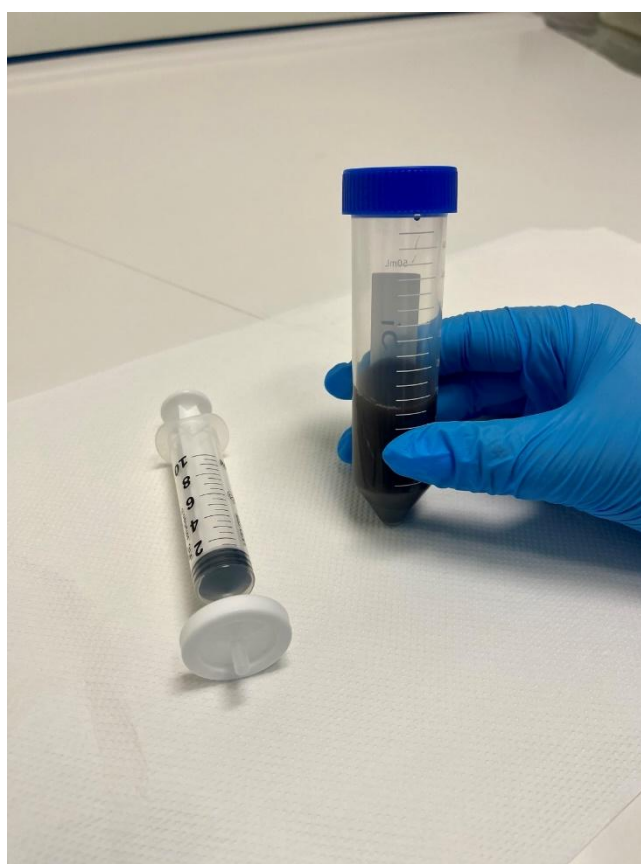
Εικόνα 3.6.2.iv: Συλλογή δείγματος 5mL από κάθε αντιδραστήρα.
