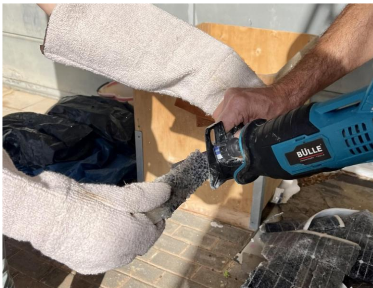
Εικόνα 3.2.1: Τεμαχισμός φωτοβολταϊκού πάνελ.
