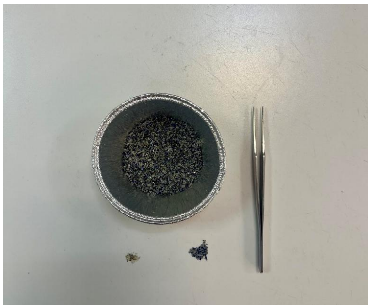
Εικόνα 3.5.3: Μίγμα θραυσμάτων πάνελ-γυαλιού που στη συνέχεια διαχωρίστηκε χειρωνακτικά με λαβίδα.
