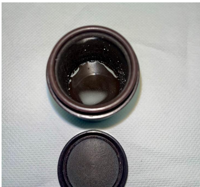
Εικόνα 3.6.2.iii: Εσωτερικό υδροθερμικού αντιδραστήρα, μετά τον κλίβανο.
