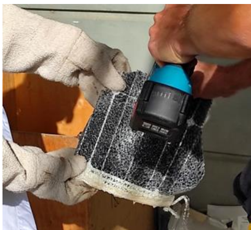
Εικόνα 18: Χειρωνακτικός διαχωρισμός με σπαθосέγα.
