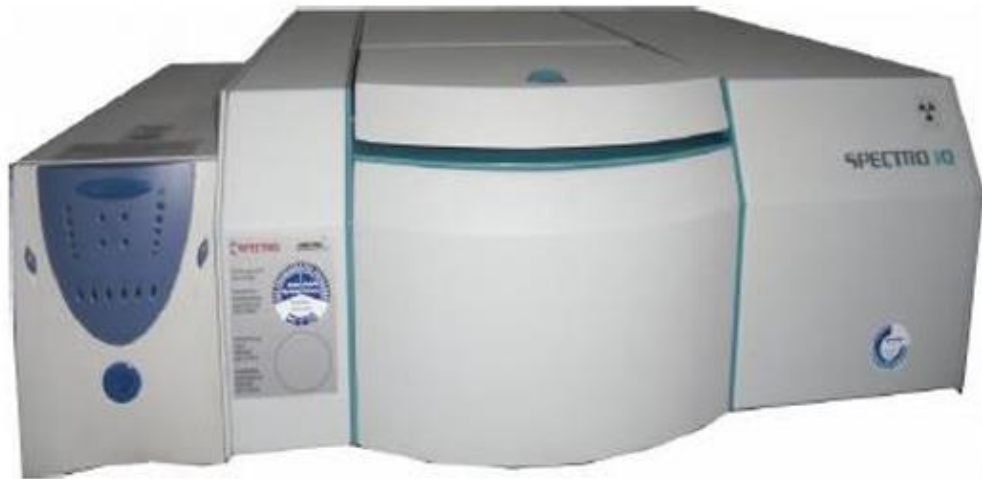
Εικόνα 34:Εργαστηριακό όργανο για τη φθορισμετρία : Spectro-X Lab Pro.
