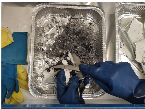
Εικόνα 20: Διαχωρισμός Tedlar με μαχαίρι.
