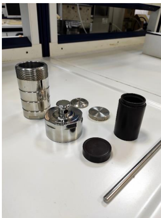
Εικόνα 30:Μέρη υδροθερμικού αντιδραστήρα.
