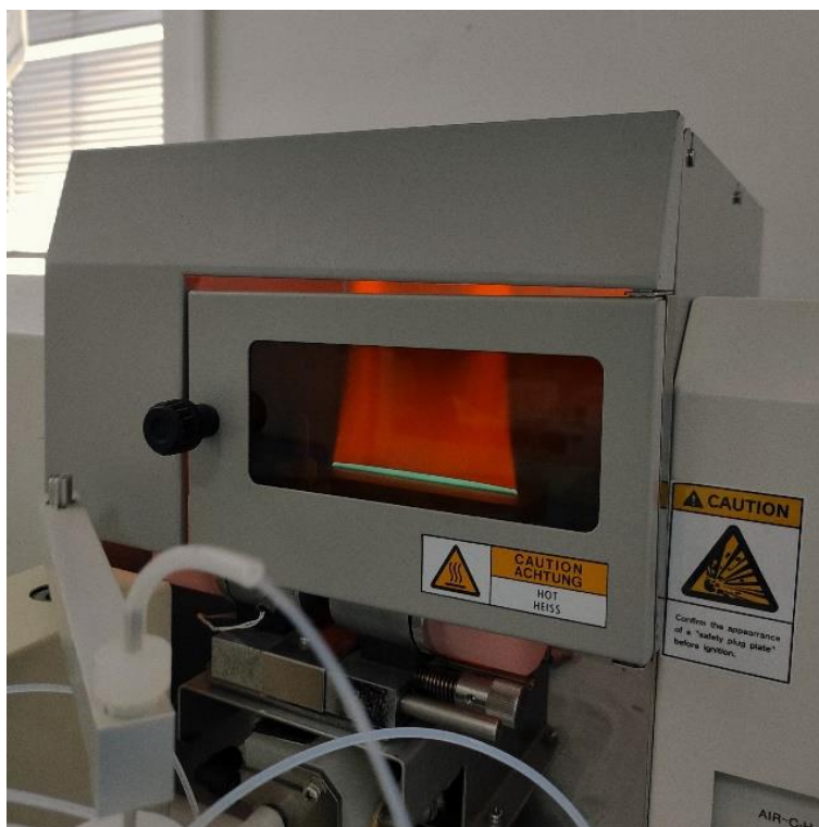
Εικόνα 33: Μηχάνημα ατομικής απορρόφησης σε λειτουργία.
