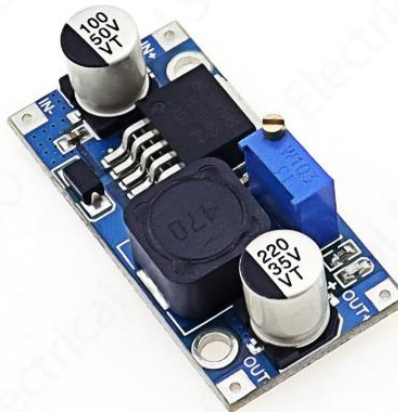
Σχήμα 2.5. Μετατροπέας υποβιβασμού τάσης (Buck converter) [54].
