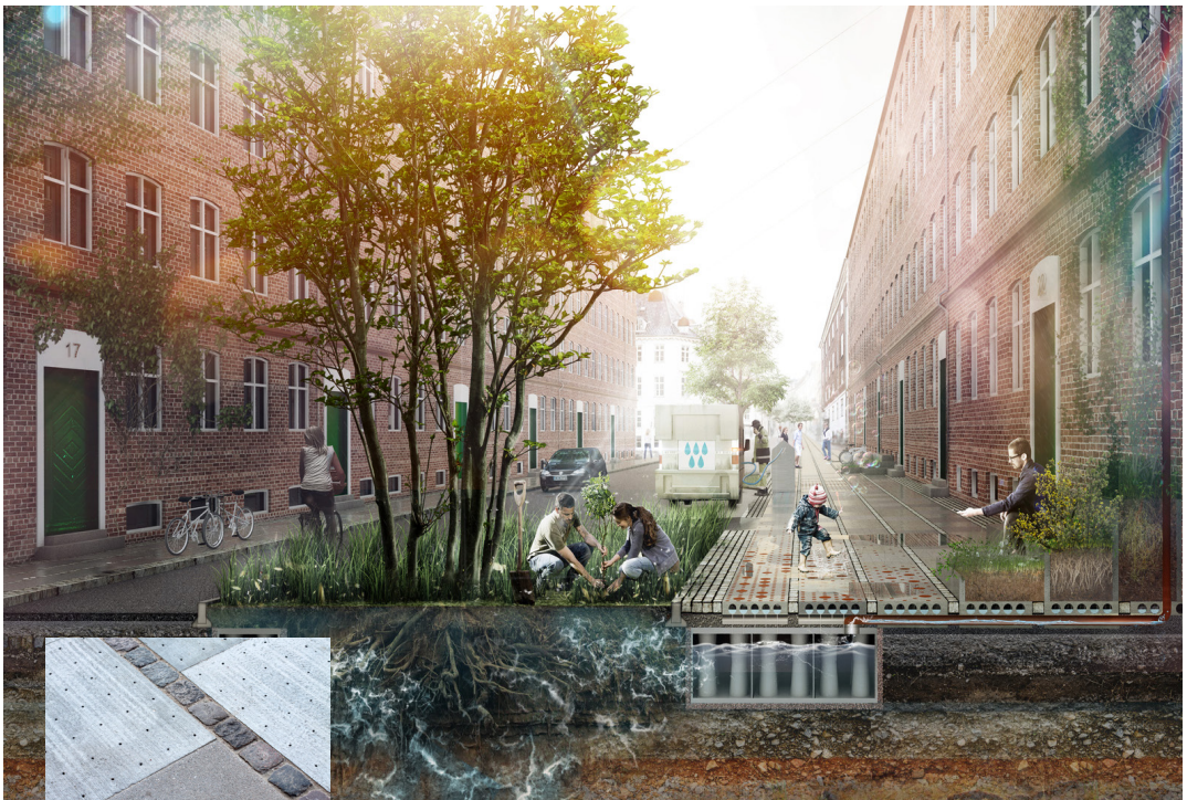
Εικόνα 25. Κλιματικά πλακίδια (climate tiles) σχεδιασμένα ως απάντηση στη κλιματικής αλλαγής. Κάλυψη αναγκών ύδρευσης, αντιμετώπιση πλημμυρών και ενίσχυση των υπόγειων πηγών.
