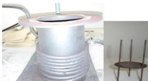
Εικόνα 3.5. Αντιδραστήρας από ανοξείδωτο χάλυβα και πυράντοχη σίτα.
