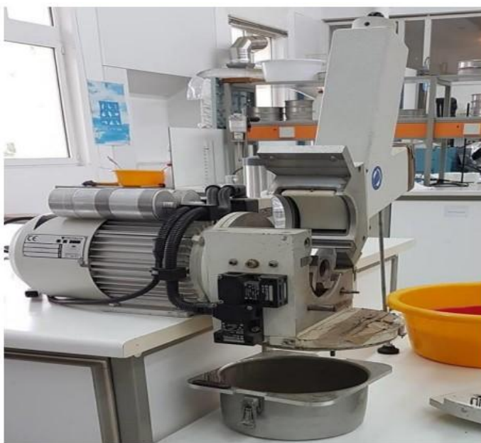
Εικόνα 3.1. Μαχαιρόμυλος άλεσης τύπου PULVERISETTE 15.
