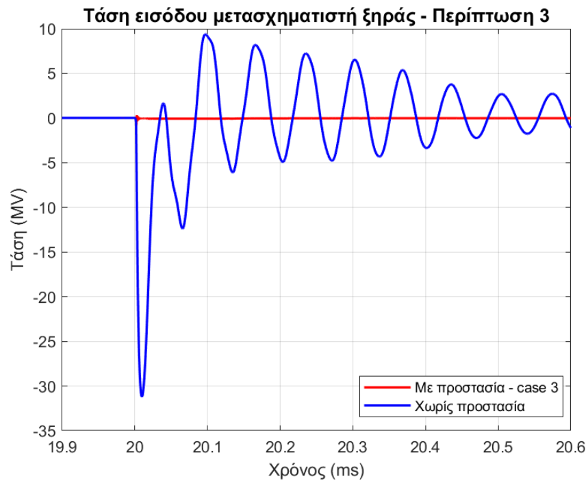
Εικόνα 116. Τάση εισόδου μετασχηματιστή ξηράς, για την τρίτη περίπτωση προστασίας και την περίπτωση χωρίς προστασία, σε κοινούς άξονες, για αρνητικό κεραυνό LPL-I.
