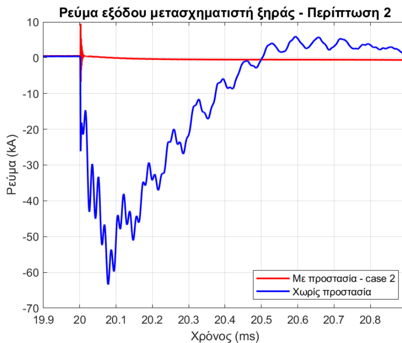
Εικόνα 106. Ρεύμα εξόδου μετασχηματιστή ξηράς, για τη δεύτερη περίπτωση προστασίας και την περίπτωση χωρίς προστασία, σε κοινούς άξονες, για αρνητικό κεραυνό LPL-I.
