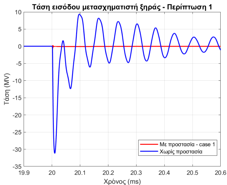
Εικόνα 94. Τάση εισόδου μετασχηματιστή ξηράς, για την πρώτη περίπτωση προστασίας και την περίπτωση χωρίς προστασία, σε κοινούς άξονες, για αρνητικό κεραυνό LPL-I.
