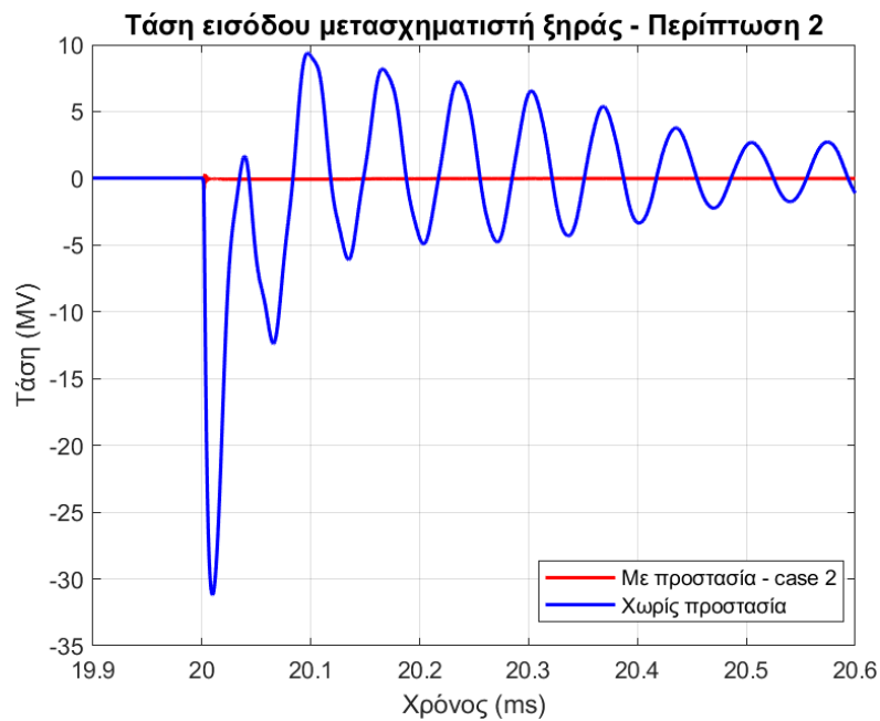
Εικόνα 105. Τάση εισόδου μετασχηματιστή ξηράς, για τη δεύτερη περίπτωση προστασίας και την περίπτωση χωρίς προστασία, σε κοινούς άξονες, για αρνητικό κεραυνό LPL-I.
