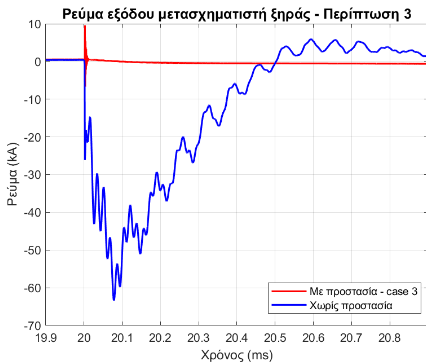
Εικόνα 117. Ρεύμα εξόδου μετασχηματιστή ξηράς, για την τρίτη περίπτωση προστασίας και την περίπτωση χωρίς προστασία, σε κοινούς άξονες, για αρνητικό κεραυνό LPL-I.
