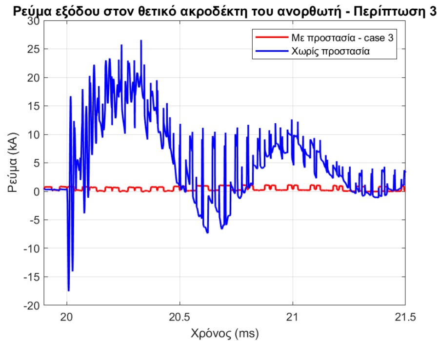
Εικόνα 120. Ρεύμα εξόδου ανορθωτή στον θετικό ακροδέκτη, για την τρίτη περίπτωση προστασίας και την περίπτωση χωρίς προστασία, σε κοινούς άξονες, για αρνητικό κεραυνό LPL-I.
