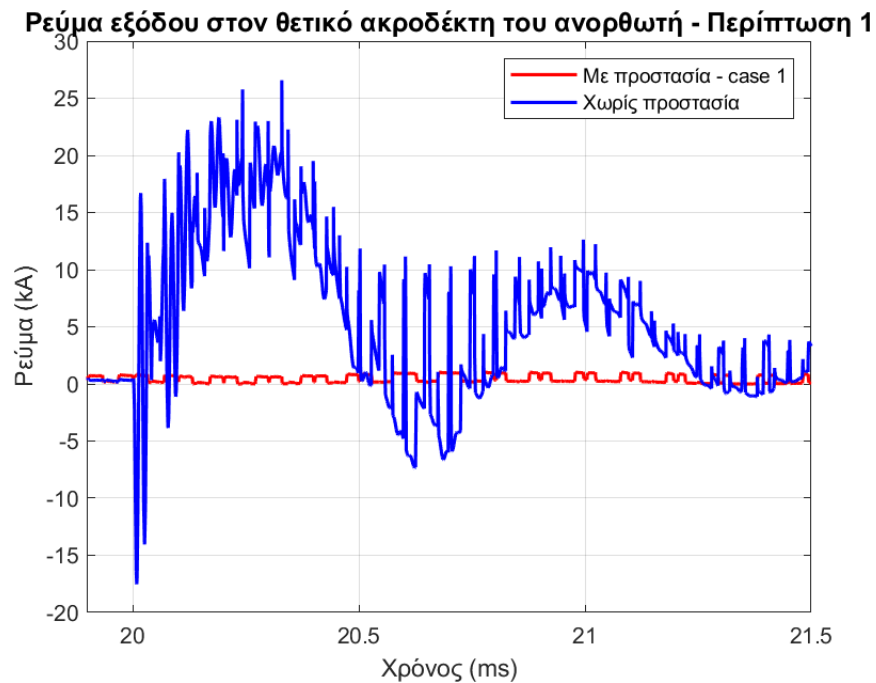
Εικόνα 98. Ρεύμα εξόδου ανορθωτή στον θετικό ακροδέκτη, για την πρώτη περίπτωση προστασίας και την περίπτωση χωρίς προστασία, σε κοινούς άξονες, για αρνητικό κεραυνό LPL-I.
