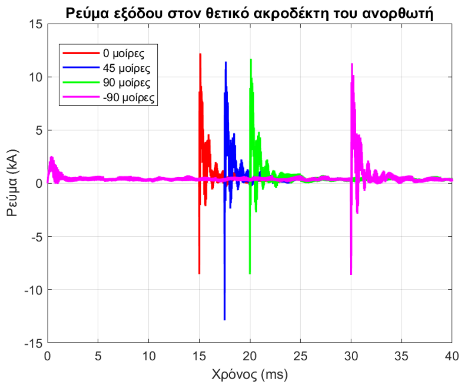
Εικόνα 83. Ρεύματα εξόδου ανορθωτή στον θετικό ακροδέκτη, έπειτα από κεραυνικό πλήγμα σε διαφορετικές γωνίες – επακόλουθο πλήγμα.
