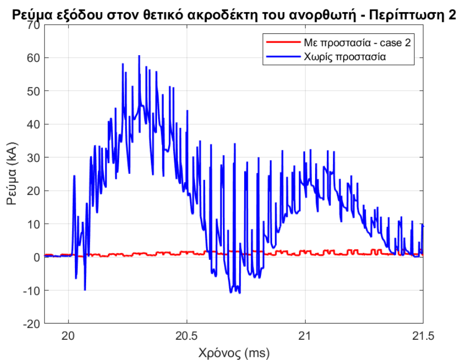
Εικόνα 131. Ρεύμα εξόδου ανορθωτή στον θετικό ακροδέκτη, για τη δεύτερη περίπτωση προστασίας και την περίπτωση χωρίς προστασία, σε κοινούς άξονες, για θετικό κεραυνό LPL-I.
