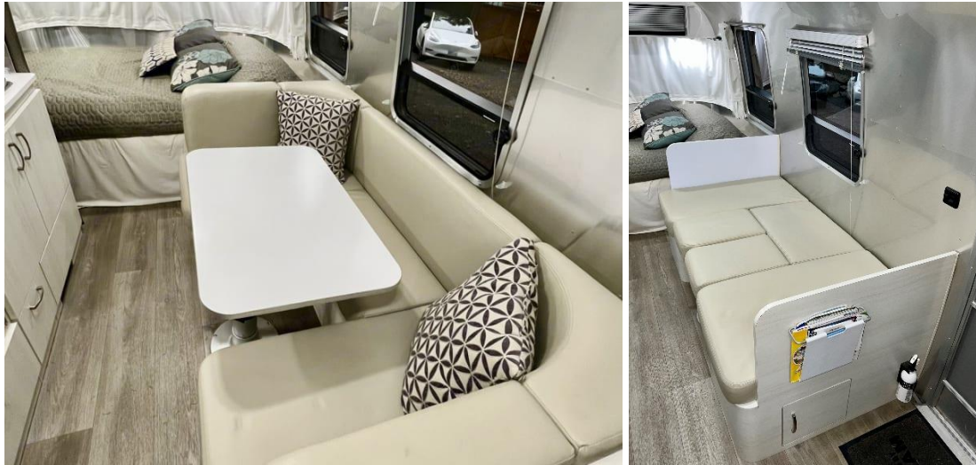
Εικόνα 49: Η μετατροπή από καναπές σε κρεβάτι του Airstream Sport 22FB
