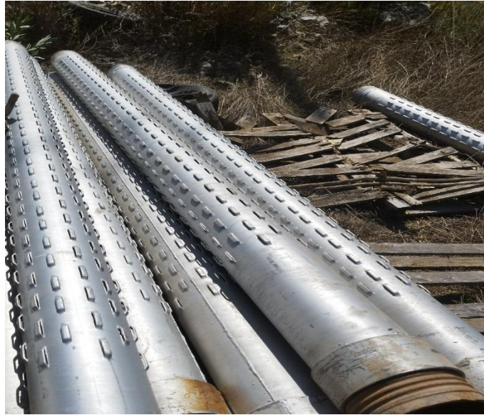
Εικόνα 4.12: Φιλτροσωλήνες τύπου γέφυρας 3 μέτρων (Βουδούρης & Μαρίνος, 2010).
