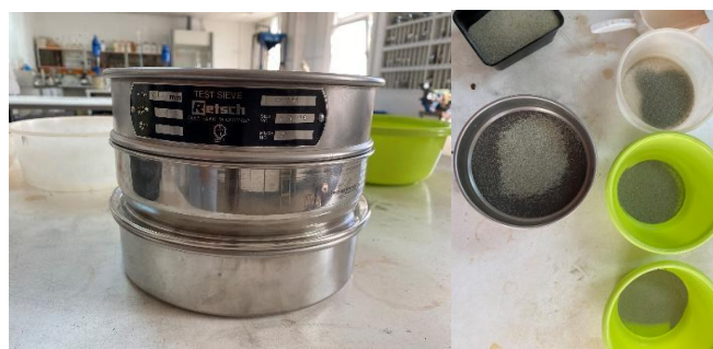
Εικόνα 10: Αριστερά: Μέγεθος πρώτου κόσκινου (πάνω) 600 \mu m, μέγεθος δεύτερου κόσκινου (στη μέση) 355 \mu m, Δεξιά: Τα 3 τελικά μεγέθη κόκκων +600 \mu m, -600+355 \mu m και -355 \mu m.
