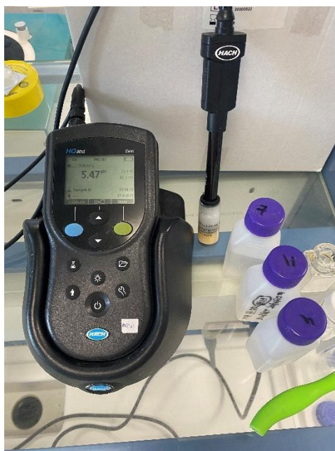
Εικόνα 14: Ψηφιακό φορητό pH-μετρο της εταιρείας Hach, μοντέλο HQ30d flexi (αριστερά), ηλεκτρόδιο βυθισμένο σε κατάλληλο διάλυμα συντήρησης, για όσο δε χρησιμοποιείται (στη μέση), ρυθμιστικά διαλύματα (buffer solutions) γνωστών τιμών pH (δεξιά)
