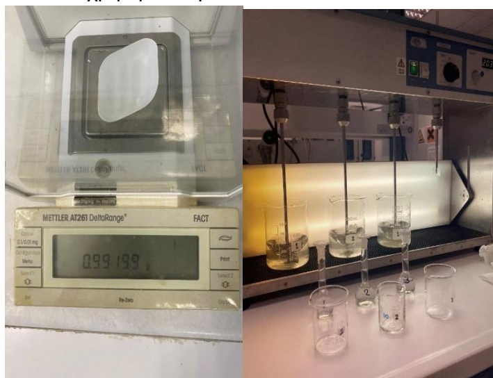
Εικόνα 16: Εργαστηριακός ζυγός ακριβείας Mettler AT261 DeltaRange®, πλαστική κάψα ζύγισης δείγματος κλινοπτιλόλιθου (αριστερά), Αντιδραστήρες διαλείποντος έργου, γυάλινα ποτήρια ζέσεως και ογκομετρικές φιάλες (δεξιά)
