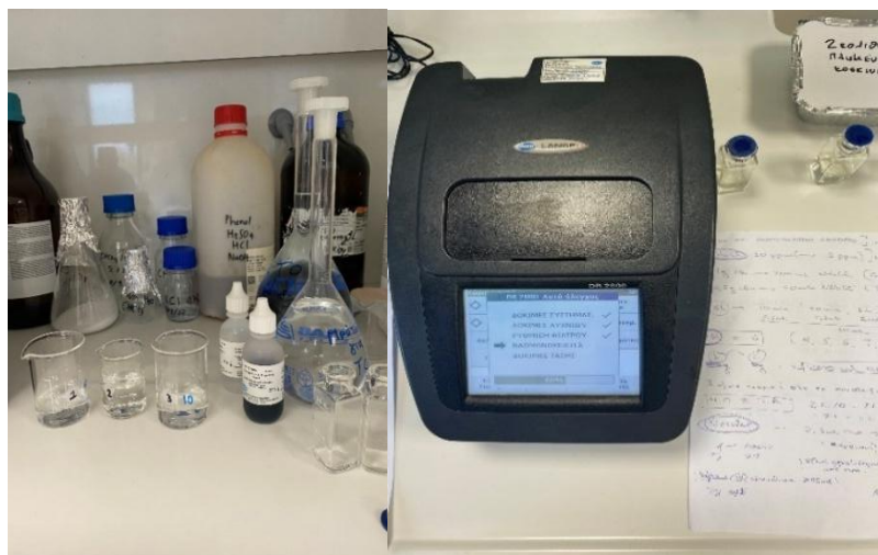
Εικόνα 17: Αριστερά: Αντιδραστήρια Mineral stabilizer (διάφανο), Polyvinyl alcohol (κόκκινο), Nessler Reagent, ποτήρια ζέσεως δειγματοληψίας, κυψελίδες 25mL, ογκομετρικοί κύλινδροι με πώμα, Δεξιά: Φασματοφωτόμετρο HACH DR2800
