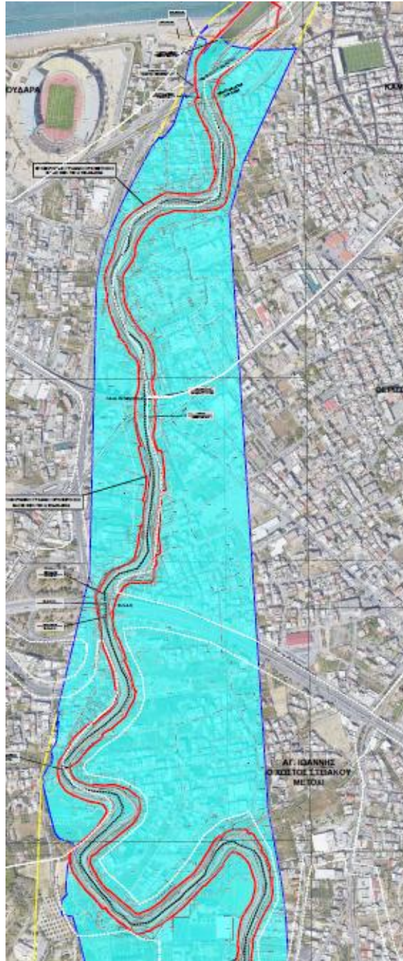
Σχήμα 4. 47. Έκταση πλημμύρας για περίοδο επαναφοράς T=50 ετών σύμφωνα με μελέτη εκ νέου Οριοθέτησης τμήματος της πεδινής κοίτης του ποταμού Γιόφυρου.
