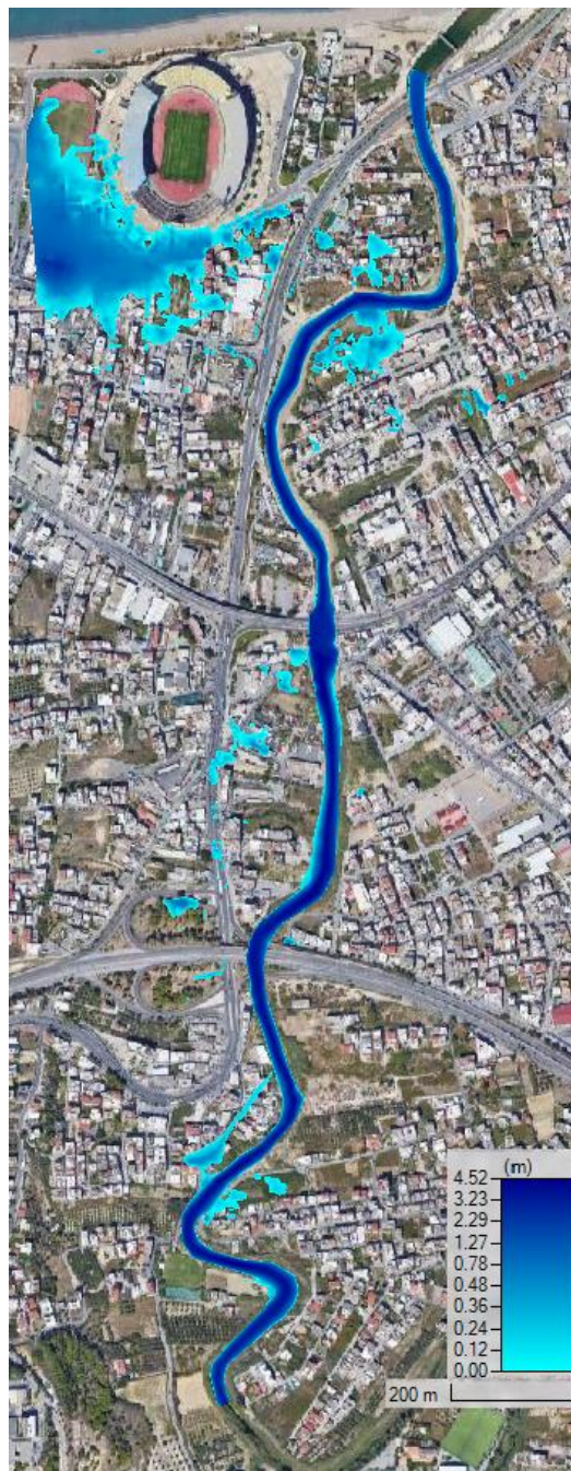
Σχήμα 4. 35. Αποτέλεσμα προσομοίωσης για Q=105 \text{ m}^3/\text{sec}
