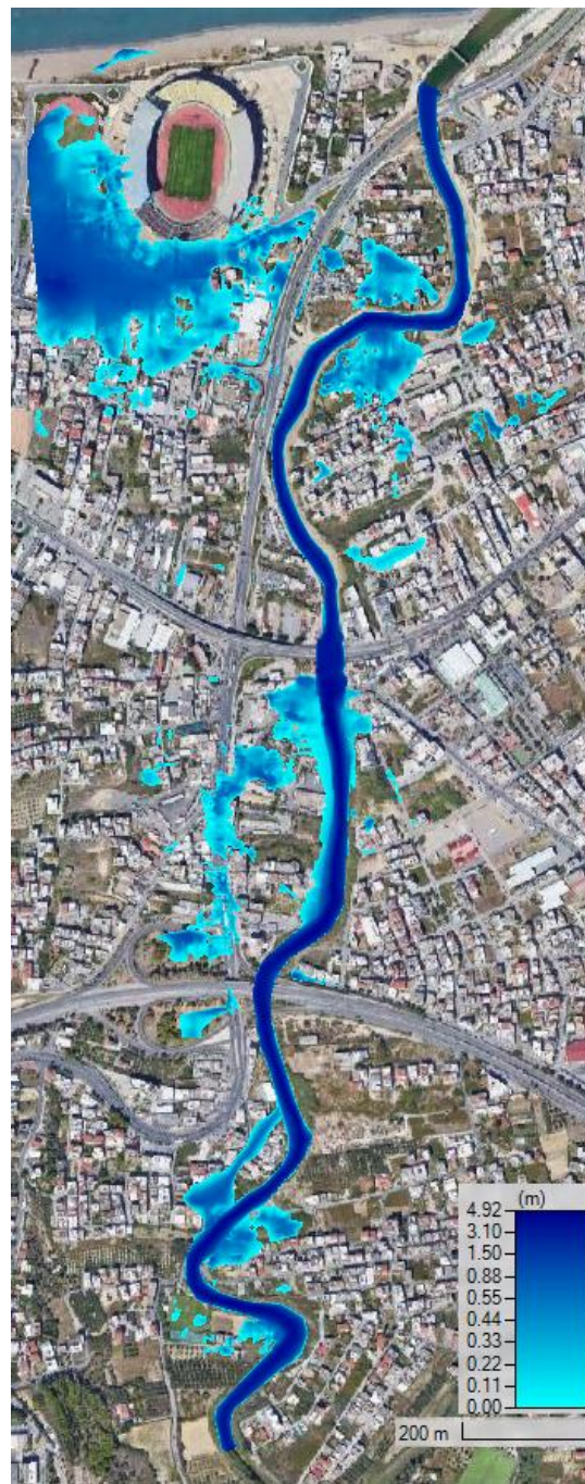
Σχήμα 4. 37. Αποτέλεσμα προσομοίωσης για Q=140 \text{ m}^3/\text{sec}
