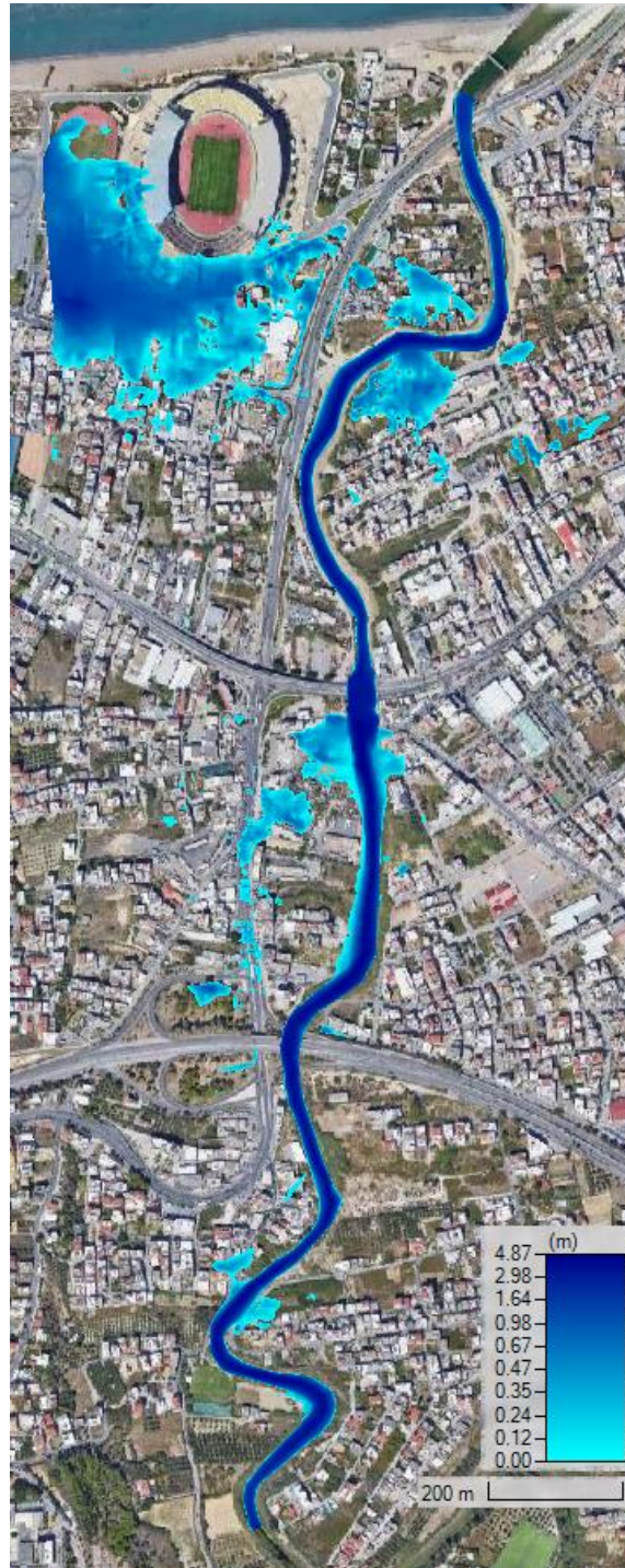
Σχήμα 4. 41. Αποτέλεσμα προσομοίωσης για Q=160 \text{ m}^3/\text{sec} και n=0.0225
