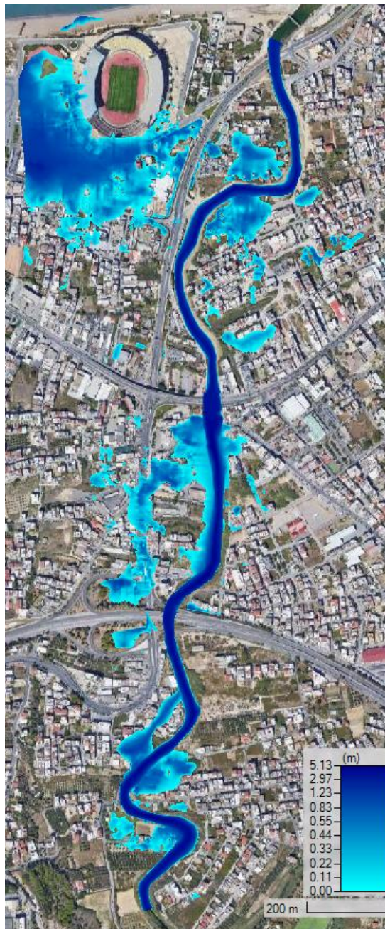
Σχήμα 4. 39. Αποτέλεσμα προσομοίωσης για Q=160 \text{ m}^3/\text{sec}
