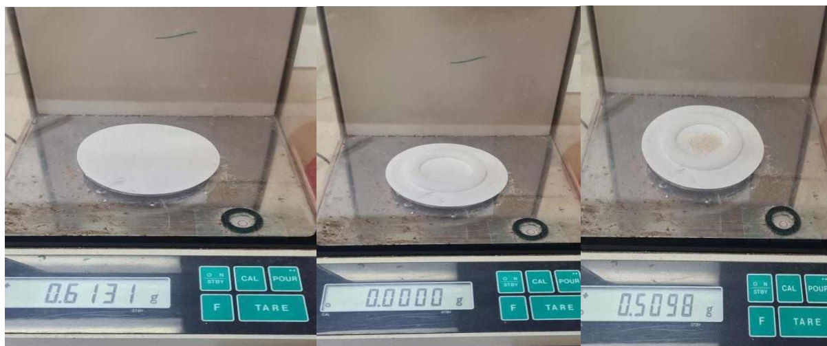
Εικόνα 20: Ζύγισμα του δείγματος με την χρήση πλαστικού δακτυλίου για την διατήρηση ομοιόμορφου σχήματος και την προετοιμασία για την μέθοδο κεραμικής πλάκας
