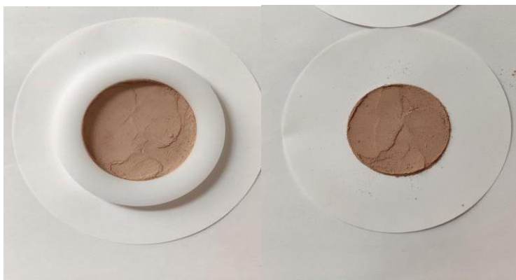
Εικόνα 21: Τοποθέτηση δείγματος με την βοήθεια δακτυλίου και παρουσίαση μορφής δείγματος στο τελικό στάδιο
