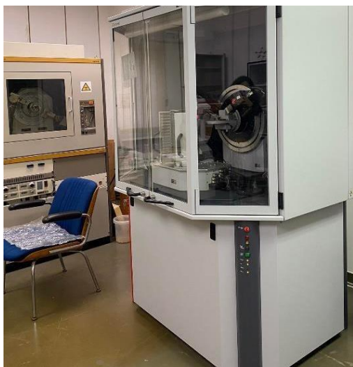
Εικόνα 14 : Περιθλασίμετρο Ακτινών X (XRD)
