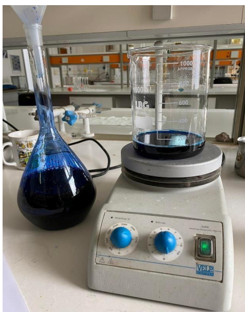
Εικόνα 16 : Παρασκευή του διαλύματος κυανού του μεθυλενίου
