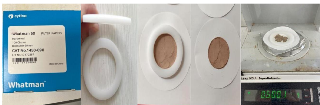
Εικόνα 21 Τοποθέτηση δείγματος επάνω σε ηθμό Whatman No. 50, στερεωμένο με κυκλικό δακτύλιο
