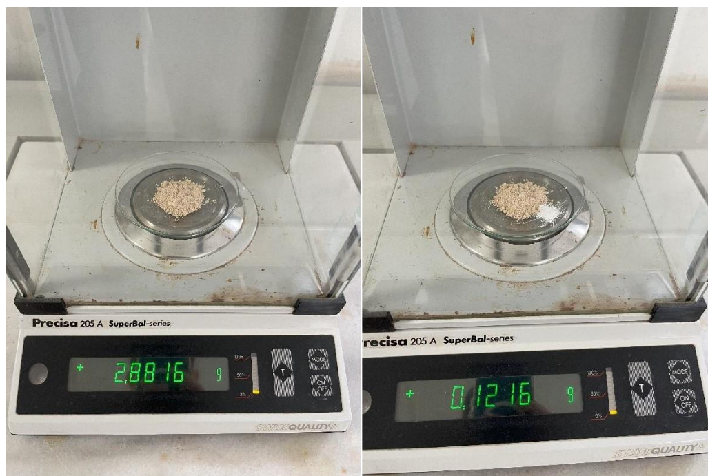
Εικόνα 16 Δείγμα 2,8816 gr και προσθήκη 0,1216 gr \text{Na}_2\text{CO}_3
