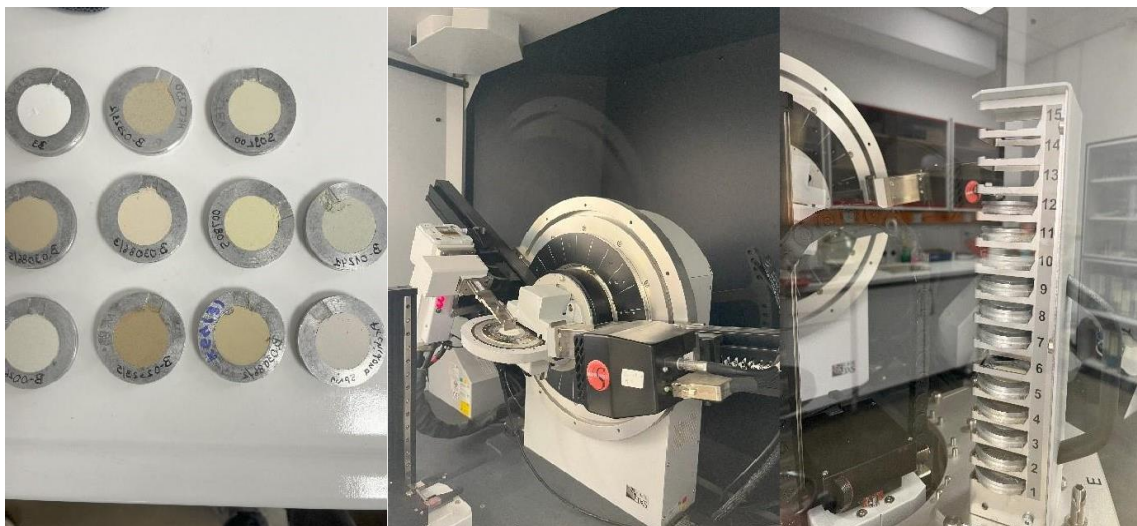
Εικόνα 8 Δείγματα έτοιμα για XRD και Περιθλασίμετρο ακτίνων-Χ (XRD) Bruker AXSD8 ADVANCE
