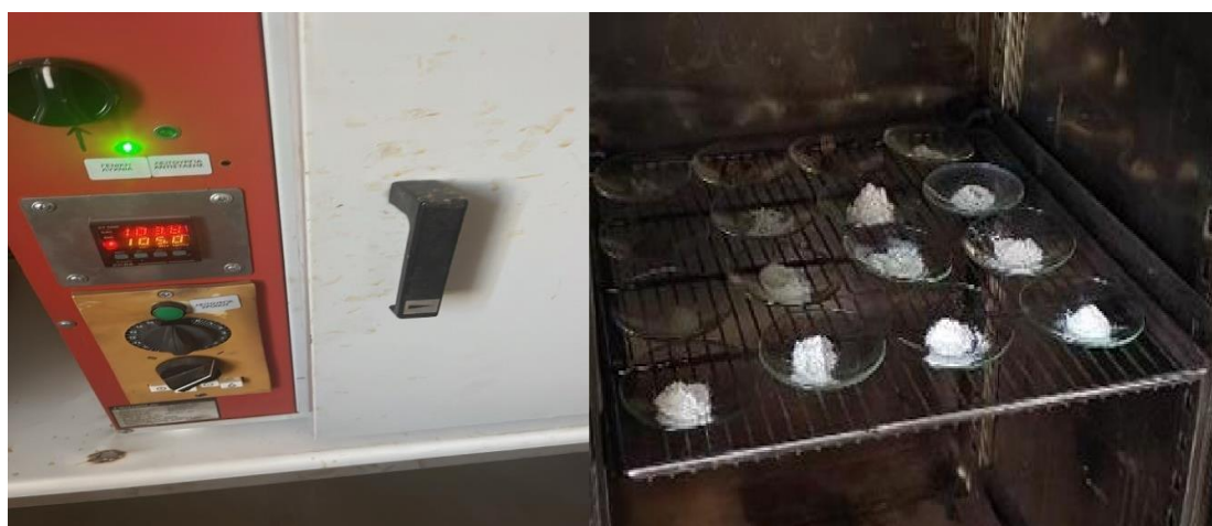
Εικόνα 17 Ξήρανση των δειγμάτων σε θερμοκρασία 105^\circ\text{C}
