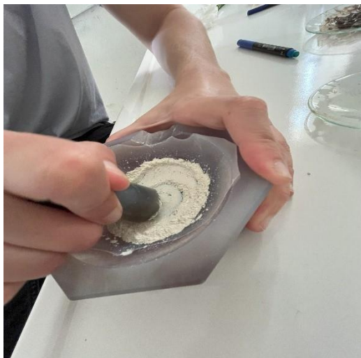
Εικόνα 6 Διαδικασία λειοτρίβησης δείγματος μπεντονίτη με γουδί και γουδοχέρι στο πλαίσιο της προετοιμασίας για XRD ανάλυση.
