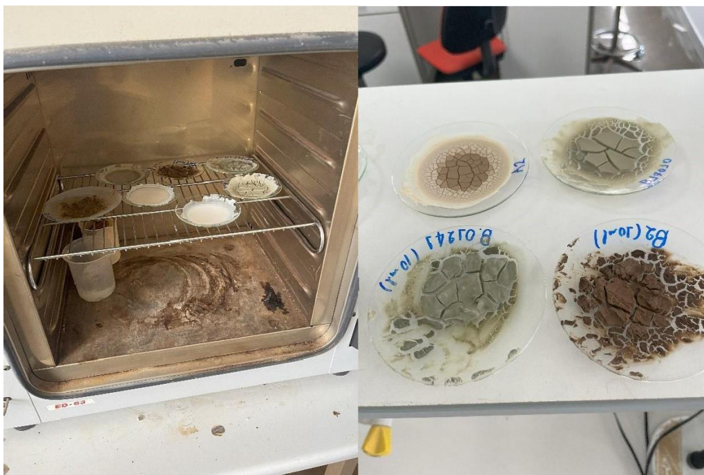
Εικόνα 20 Επανατοποθέτηση των δειγμάτων σε φούρνο στους 105 °C για πλήρη ξήρανση μετά την ανάμειξη
