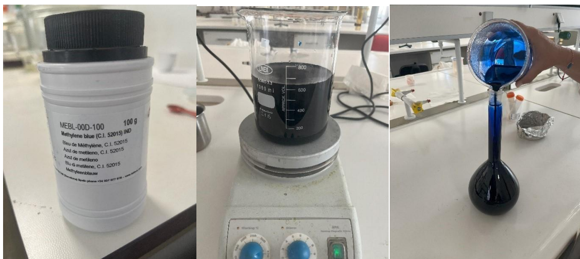
Εικόνα 25 Παρασκευή διαλύματος κυανού του μεθυλενίου
