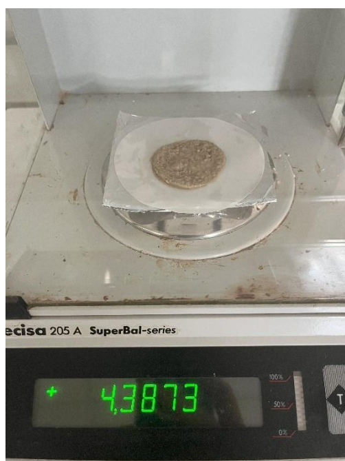
Εικόνα 23 Ζύγιση του δείγματος μετά το Plate Test με στόχο τον περιορισμό απώλειας υγρασίας
