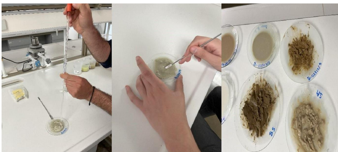
Εικόνα 19 Προσθήκη 10 ml απιονισμένου νερού και ανάδευση του δείγματος έως ότου σχηματιστεί ομοιογενής πάστα
