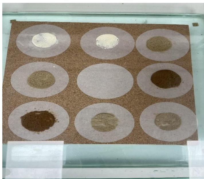
Εικόνα 22 Plate test για 4 δείγματα και ένα τυφλό
