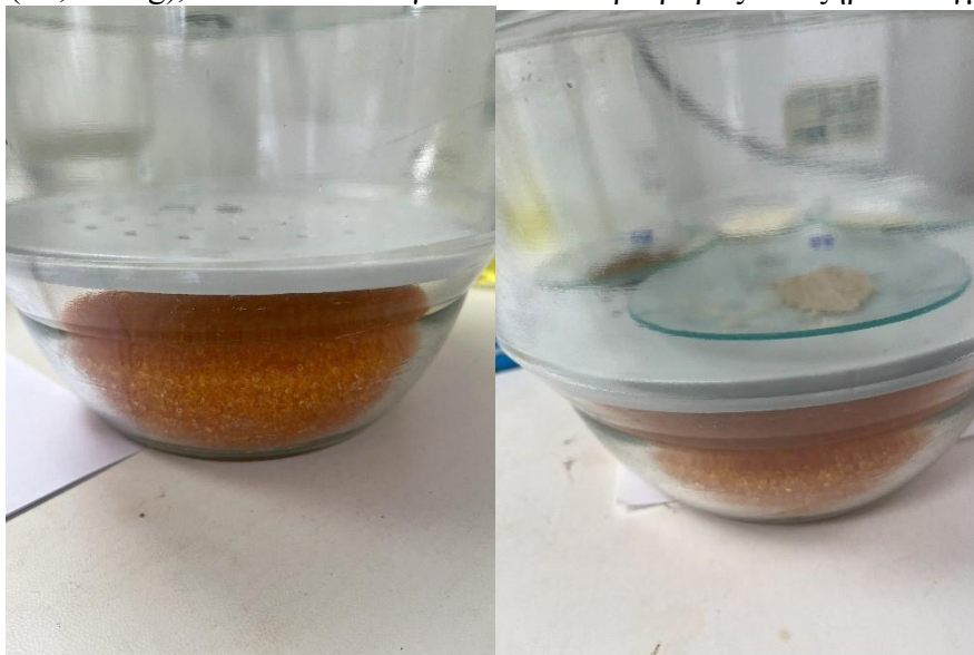
Εικόνα 18 Μεταφορά και ψύξη των δειγμάτων σε ξηραντήρα
