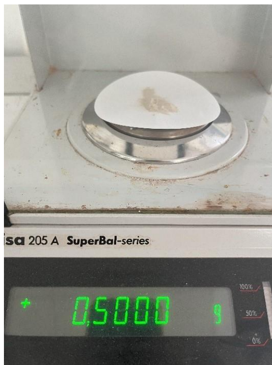
Εικόνα 26 ζύγιση δείγματος με αναλυτικό ζυγό ακριβείας \pm 0,0001 g
