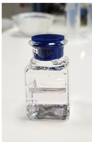
Εικόνα 23: Τελικό διάλυμα μετά την προσθήκη 6,0 \cdot 10^3 \text{ mg/L} μεταδιθειώδους νατρίου, γλυκερίνης και δείκτη
