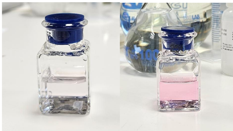
Εικόνα 21: Το τελικό διάλυμα, μετά την προσθήκη θειοθειικού νατρίου, γλυκερίνης και δείκτη (από τα αριστερά προς τα δεξιά), για τις ποσότητες 4,1 \cdot 10^3 \text{ mg/L} και 2,0 \cdot 10^3 \text{ mg/L} θειοθειικού νατρίου
