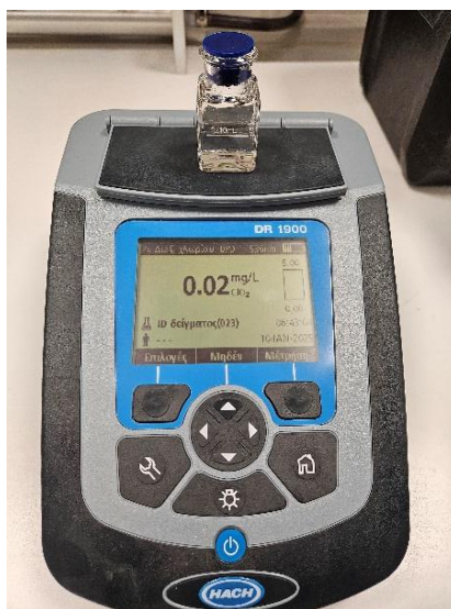
Εικόνα 22: Ποσότητα υπολειμματικού \text{ClO}_2 μετά από αποχλωρίωση με θειοθειικό νάτριο σε μορφή δισκίου ποσότητας 3,5 \cdot 10^3 mg/L
