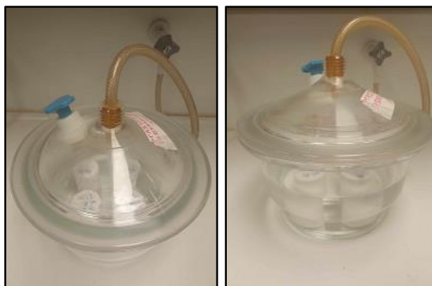
Σχήμα 3.7 Φωτογραφίες από διάφορα στάδια της εργαστηριακής δοκιμής για τον προσδιορισμό της φαινόμενης πυκνότητας και του ανοικτού πορώδους των δειγμάτων μαρμάρου από το Λατομείο «ΠΥΡΓΩΝ», κατά EN 1936.
