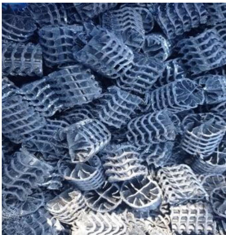
Εικόνα 3.6: Το ανακυκλωμένο HDPE που χρησιμοποιήθηκε ως υλικό πλήρωσης στις πιλοτικές μονάδες P και C
