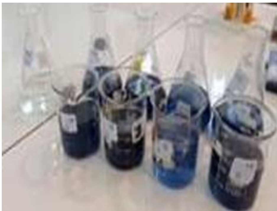
Εικόνα 3.14: Δείγματα για φασματοφωτομέτρηση με πρώτο από αριστερά το τυφλό δείγμα
