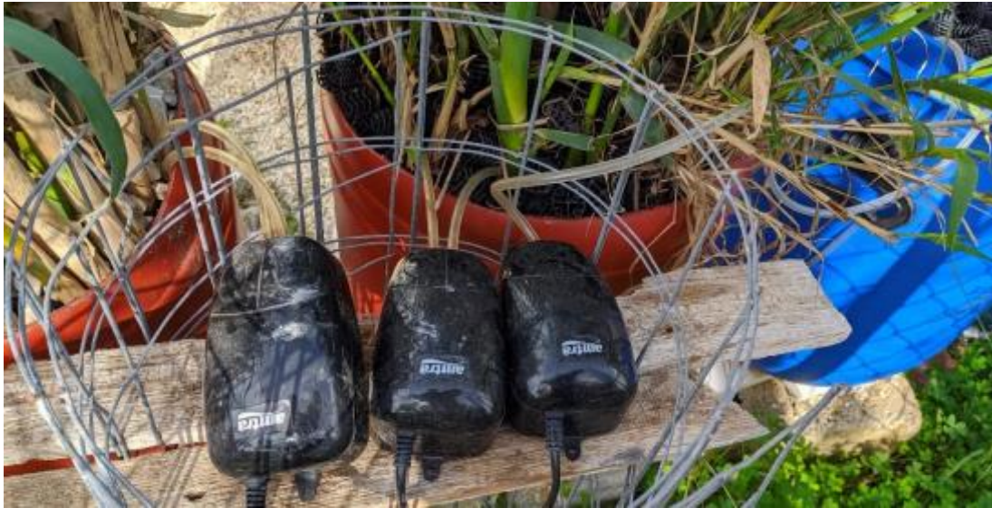
Εικόνα 3.7: Οι αεραντλίες των πιλοτικών μονάδων
