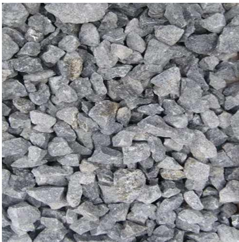
Εικόνα 3.5: Το χαλίκι που χρησιμοποιήθηκε ως υλικό πλήρωσης στην μονάδα G
