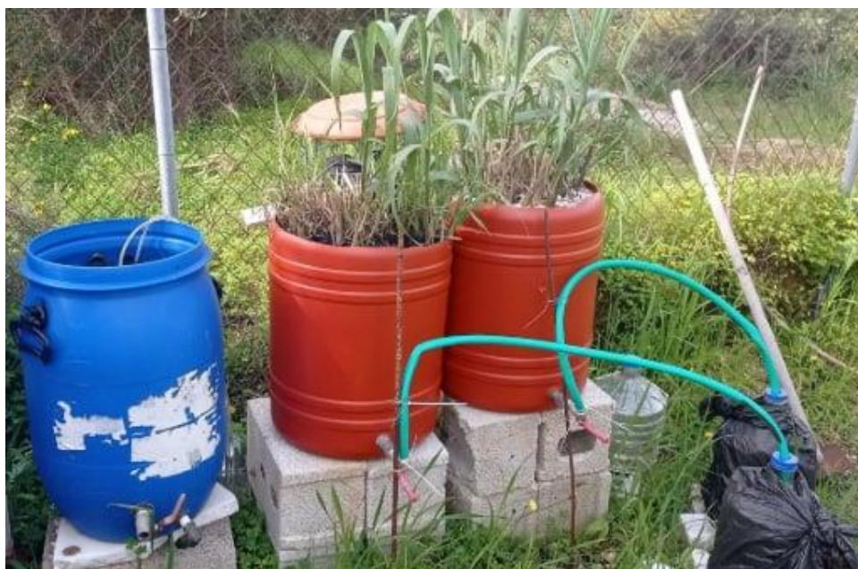
Εικόνα 3.1: Οι πιλοτικοί αεριζόμενοι τεχνητοί υγροβιότοποι του πειράματος
