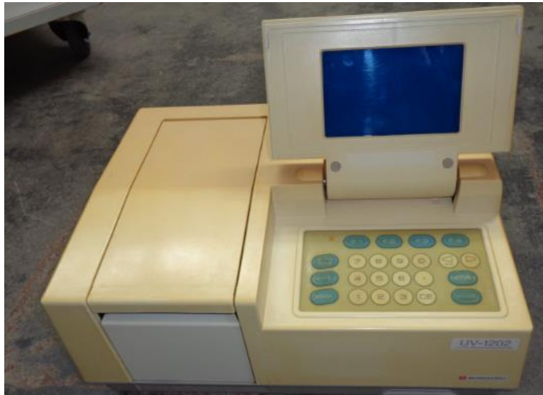
Εικόνα 3.8: Φασματοφωτόμετρο SHIMADZU UV-1202
