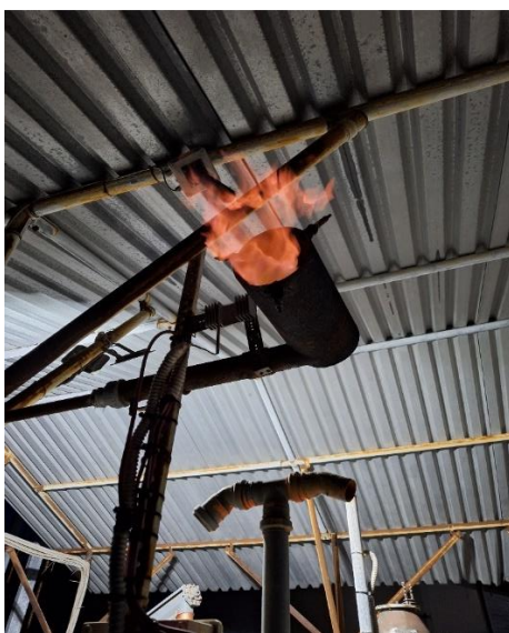
Εικόνα 4.4 Πυρσός καύσης και εμφάνιση φλόγας
