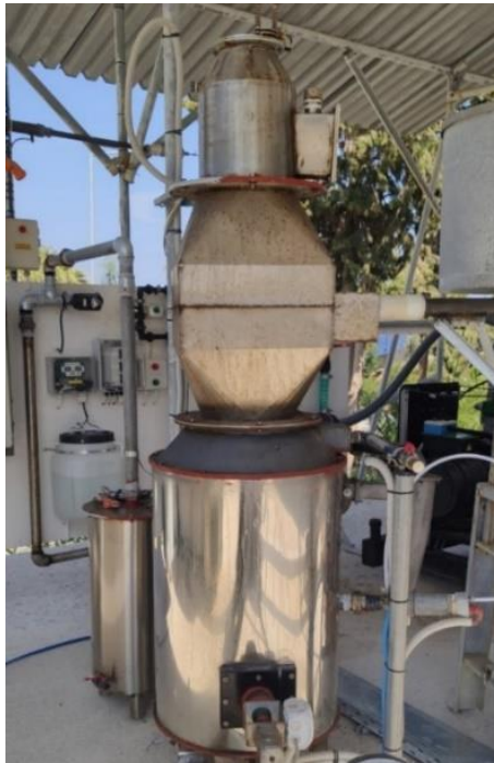
Εικόνα 3.14 Ο αεριοποιητής του προγράμματος LIFE B2E4SustWWTP
