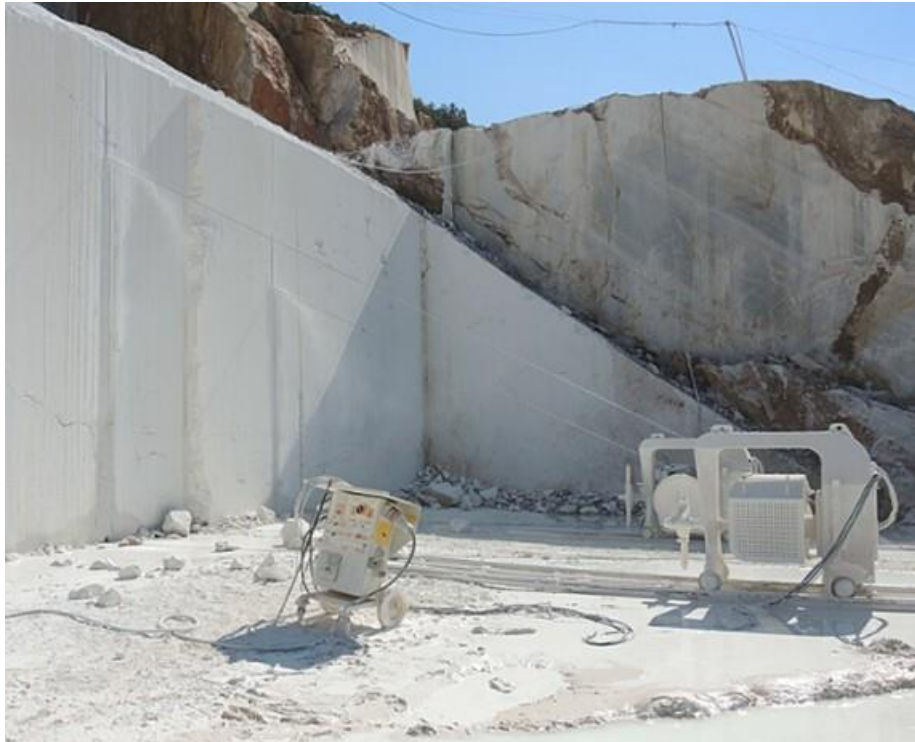
Εικόνα 4-4: Κοπή παραγωγικού μετώπου μαρμάρου
