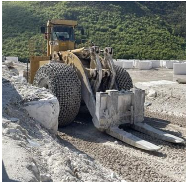
Εικόνα 4-20: Φορτωτής με ταχυσύνδεσμο και πιρούνια.
