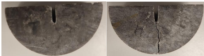
Εικόνα 4.9: Ημικυλινδρικό δοκίμιο μαρμάρου για δοκιμή κάμψης με εγκοπή, πριν και μετά την θραύση του
