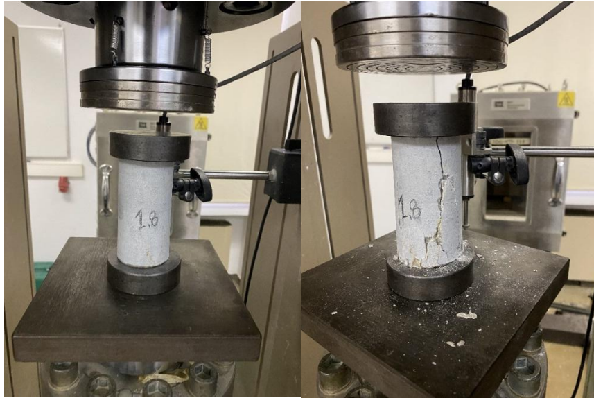
Εικόνα 4.3: Το δοκίμιο λίγο πριν και αμέσως μετά την αστοχία σε δοκιμή μονοαξονικής θλίψης.
