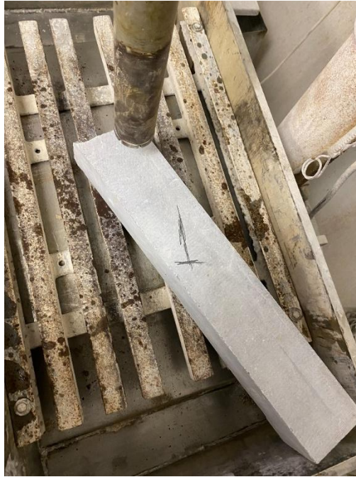
Εικόνα 4.2: Πυρηνοληψία από “μπαστούνι” μαρμάρου Γόρτυνας.
