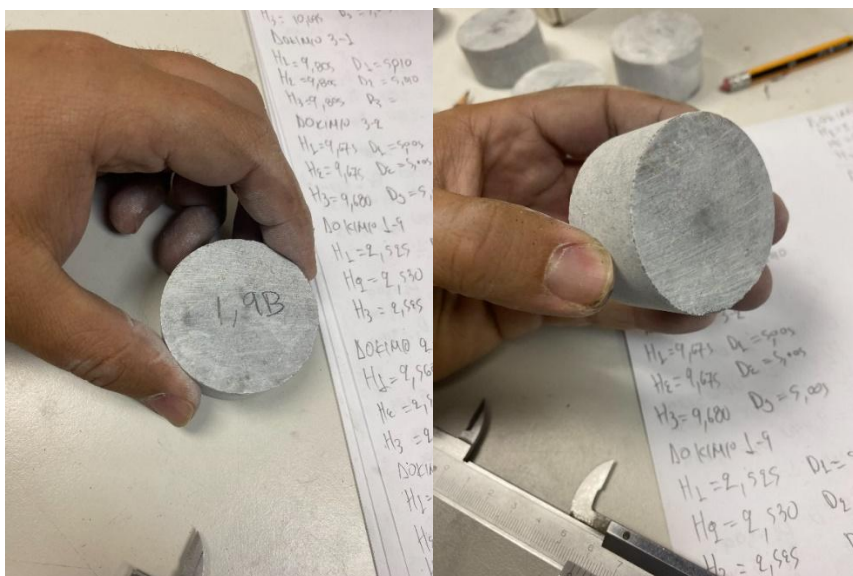
Εικόνα 4.6: Κυλινδρικά δοκίμια μαρμάρου για δοκιμή Brazil.
