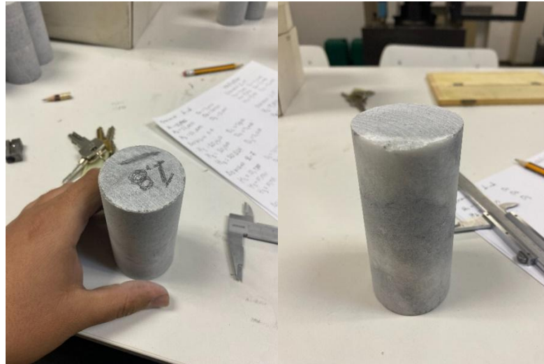
Εικόνα 4.1: Κυλινδρικό δοκίμιο μαρμάρου για δοκιμή μονοαξονικής θλίψης
