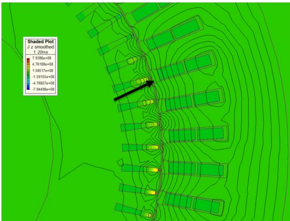
Figure 6.10 Πυκνότητα Ρεύματος στην Εικίνηση Επαγωγικού Κινητήρα με Φορτίο 11 kNm σε εσφαλμένη Κατάσταση.
