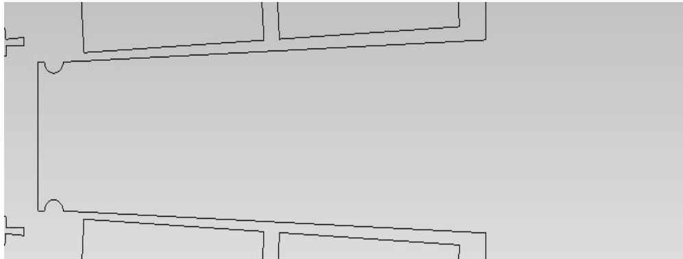
Figure 5.1 Γεωμετρία Αύλακα Στάτη.
