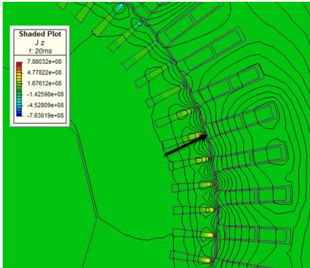
Figure 6.7 Πυκνότητα Ρεύματος στην Εκκίνηση Επαγωγικού Κινητήρα με Φορτίο 11 kNm σε υγιή Κατάσταση.
