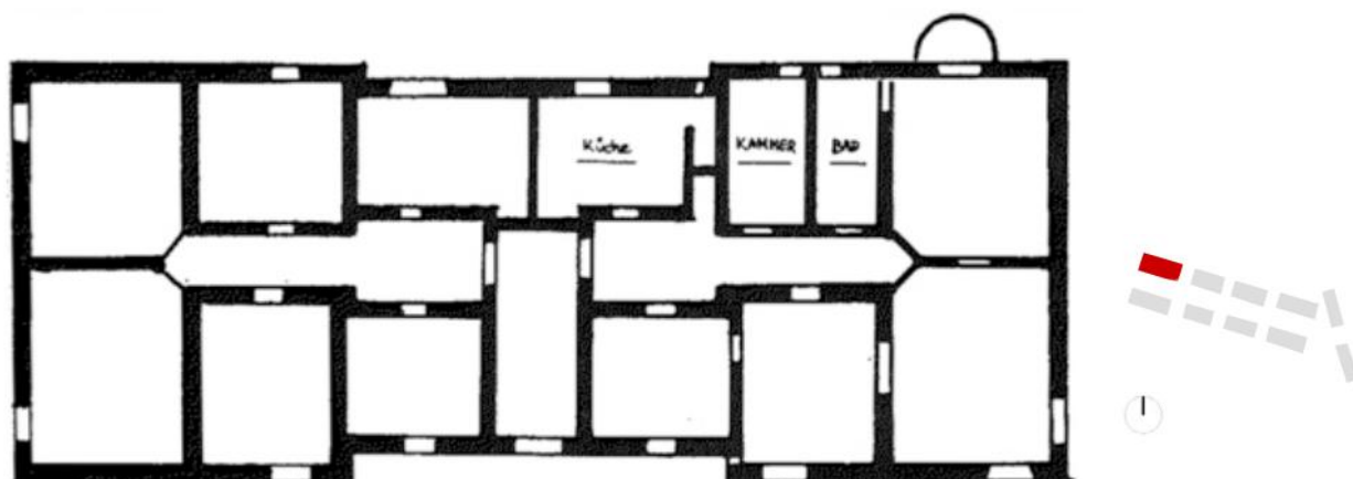
Εικ. 42: Κάτοψη ορόφου μπλε συγκροτήματος. Ορισμένη χρήση μόνο για κουζίνα, μπάνιο και αποθήκη.
