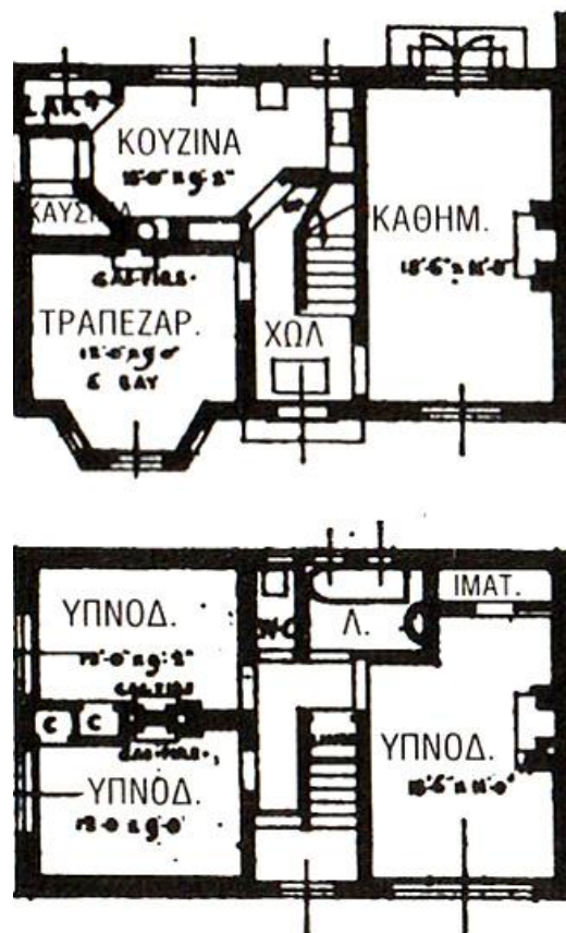
Εικ. 18: Κάτοψη ισογείου και ορόφου των εργατικών κατοικιών στην κηπούπολη Letchworth.
