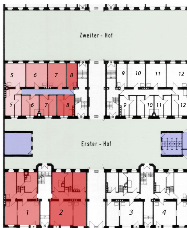
Εικ. 7: Κάτοψη ισογείου στο Mietskaserne Meyers Hof , σύγκριση διαμερισμάτων δρόμου – αυλής.
