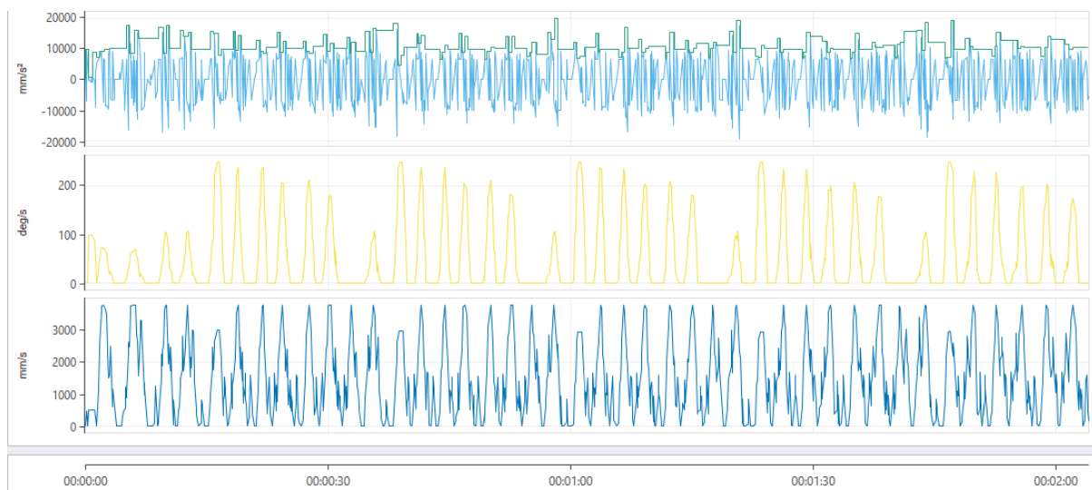
Εικόνα 7-16. Γραφική απεικόνιση της δυναμικής συμπεριφοράς του κεντρικού σημείου αναφοράς του εργαλείου που είναι προσαρτημένο στο βραχίονα (TCP) για το βελτιστοποιημένο τέταρτο μοντέλο.
