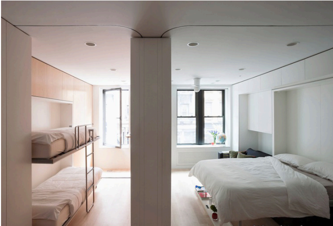
E50: Στιγμιότυπο από το εσωτερικό του μικροδιαμερίσματος LifeEdited Apartment, όπου μέσω μηχανισμού στο δάπεδο και την οροφή δίνεται η δυνατότητα μετακίνησης του εσωτερικού τοίχου για αναδιαμόρφωση και επέκταση του χώρου
