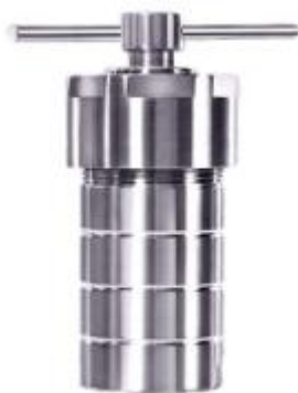
Εικόνα 14. Ο υδροθερμικός αντιδραστήρας όπου λαμβάνει χώρα η γήρανση στους 120 °C. Τα υπόλοιπα στάδια περιγράφονται στην Εικόνα 13α,γ-ε με χρήση ουρίας αντί για NaOH.
