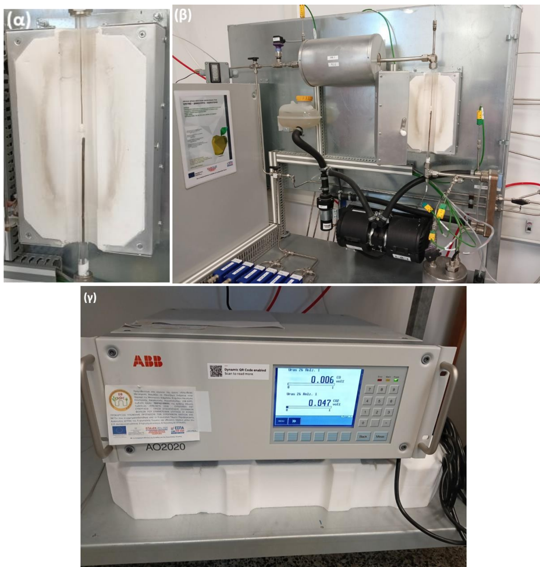
Εικόνα 18. (α) Ο αντιδραστήρας χαλαζία σταθερής κλίνης, (β) η καταλυτική μονάδα δοκιμών και (γ) ο αναλυτής CO (ABB AO2020).
