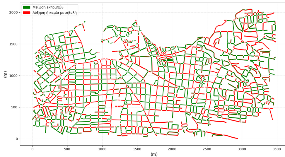
Εικόνα 4.26: Σύγκριση Χωρικής της Κατανομής των Εκπομπών HC με το Βασικό Σενάριο ανά Οδικό Τμήμα (g/km/h)
