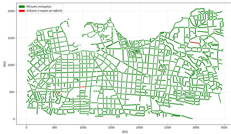
Εικόνα 4.50: Σύγκριση της Χωρικής Κατανομής των Εκπομπών CO με το Βασικό Σενάριο ανά Οδικό Τμήμα (g/km/h)
