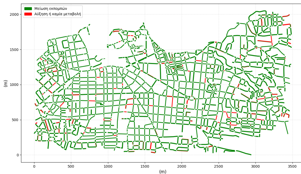
Εικόνα 4.52: Σύγκριση της Χωρικής Κατανομής των Εκπομπών PMx με το Βασικό Σενάριο ανά Οδικό Τμήμα (g/km/h)
