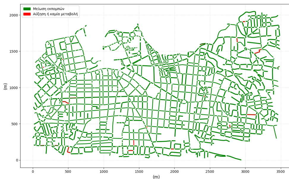
Εικόνα 4.49: Σύγκριση της Χωρικής Κατανομής των Εκπομπών CO 2 με το Βασικό Σενάριο ανά Οδικό Τμήμα (g/km/h)
