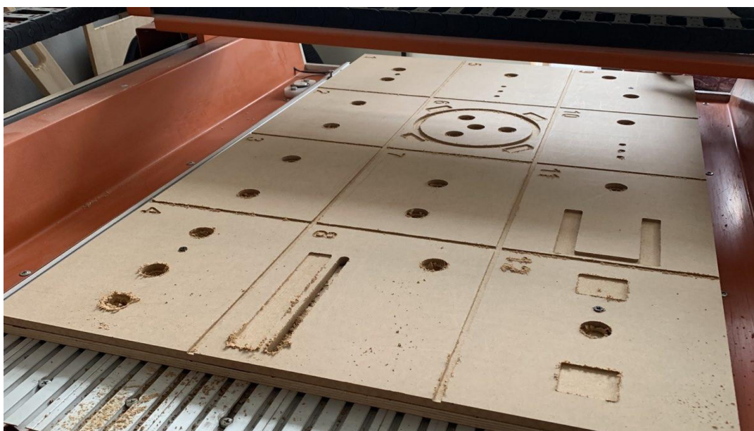
Σχήμα 4.4: Ολοκλήρωση κατεργασίας πίνακα τοποθέτησης μηχανισμών σε CNC Router
