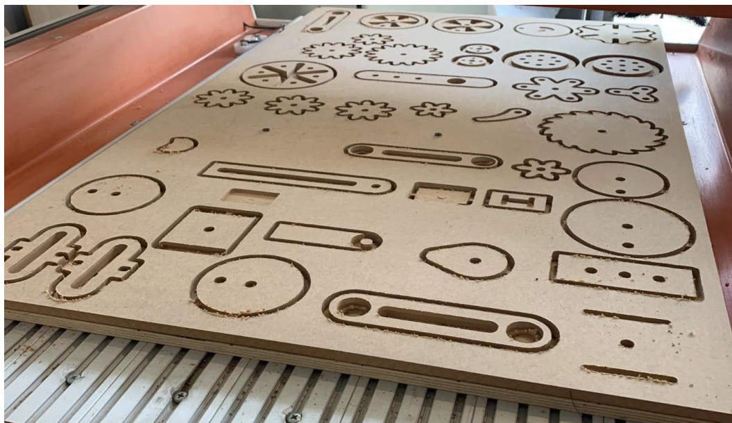
Σχήμα 4.3: Ολοκλήρωση κατεργασίας εξαρτημάτων σε CNC Router
