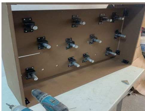
Σχήμα 4.20: Ολοκλήρωση της τοποθέτησης κινητήρων συνεχούς ρεύματος (DC)
