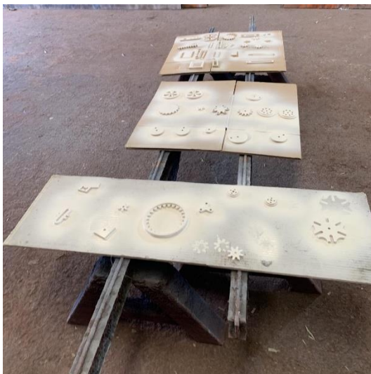
Σχήμα 4.5: Αστάρωμα επιφανειών στα εξαρτήματα
