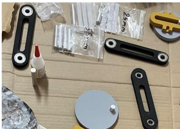
Σχήμα 4.12: Εξαρτήματα με έδρανα κύλισης
