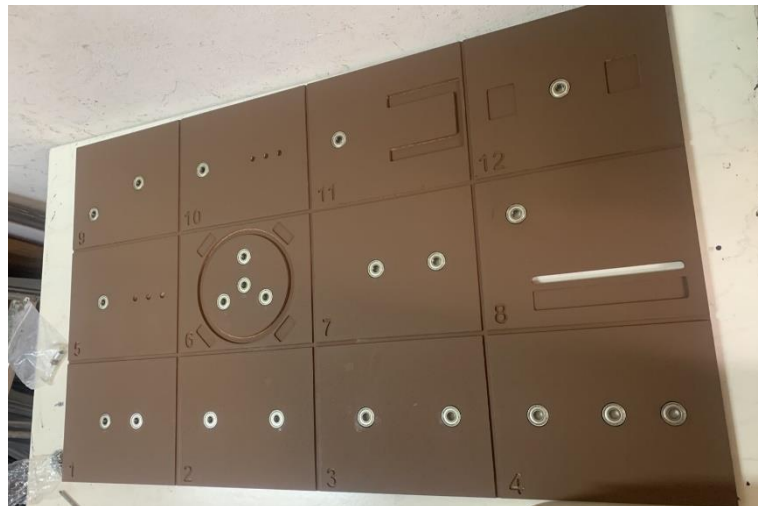
Σχήμα 4.11: Πίνακας τοποθέτησης μηχανισμών με έδρανα κύλισης
