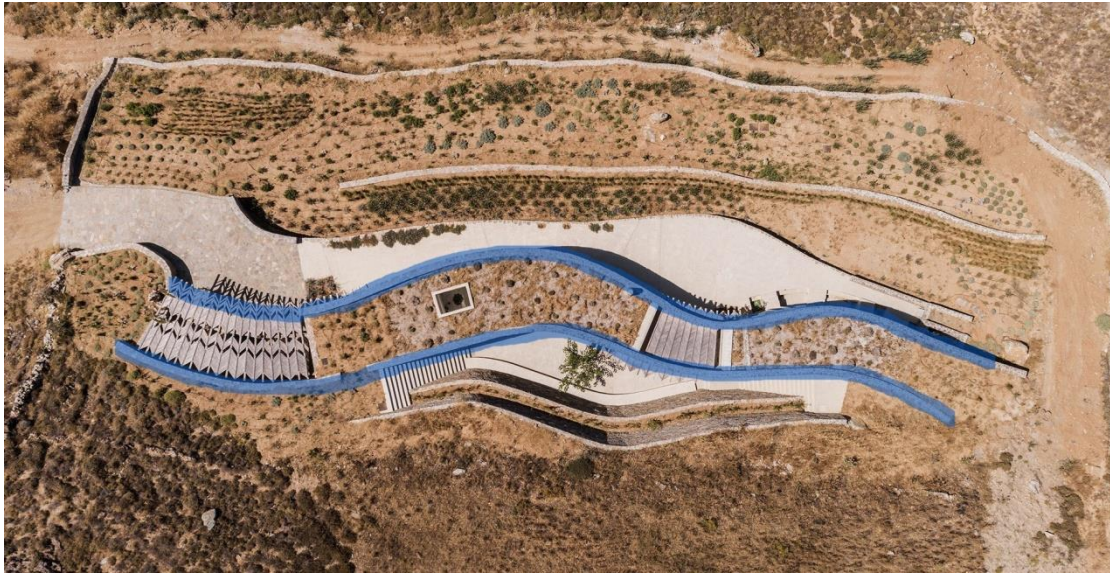
Εικόνα 84: Ξερολίθι, Σέριφος. Φυτεμένο δώμα και καμπύλο-οργανικό σχήμα κάτοψης, δύο στοιχεία που συμβάλλουν στην ενοποίηση της υπόσκαφης κατοικίας με το φυσικό τοπίο της περιοχής.
