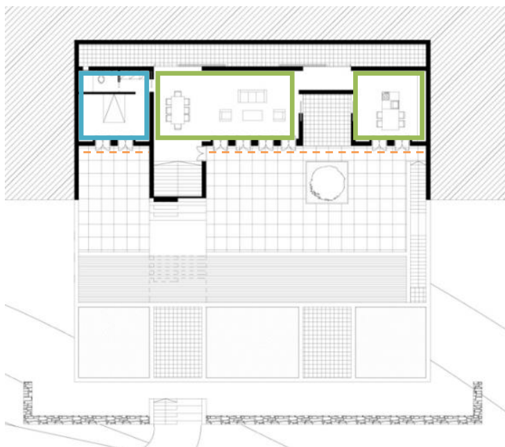
Εικόνα 66: Summer house, Νάξος. Δεύτερο επίπεδο κατοικίας με κοινόχρηστους και ιδιωτικούς χώρους τοποθετημένους σε σειρά στην ανοιχτή πλευρά της κατασκευής.
