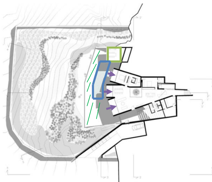
Εικόνα 67: Lapyti residence, Μύκονος. Εσωτερικοί χώροι τοποθετημένοι σε σειρά κατά μήκος της ανοιχτής πλευράς της κατασκευής με άμεση πρόσβαση στους διαμορφωμένους εξωτερικούς χώρους ( αυλή με πισίνα και εξωτερικό καθιστικό ).
