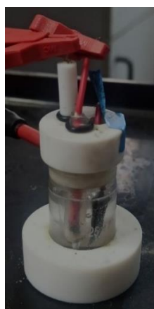
Εικόνα 2.1.4. Ηλεκτρολυτικό κελί τριών ηλεκτροδίων.
