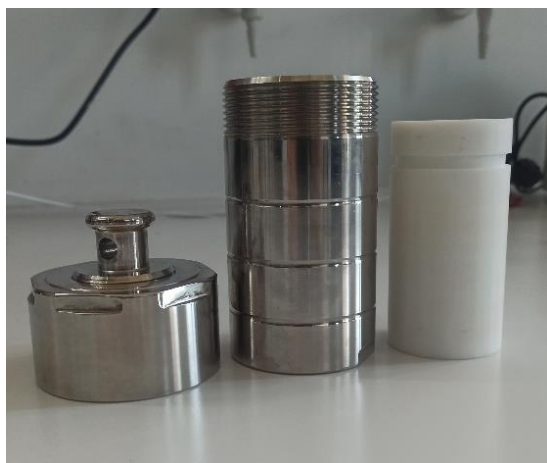
Εικόνα 2.1.2. Αντιδραστήρας υδροθερμικής σύνθεσης με επένδυση από Teflon.
