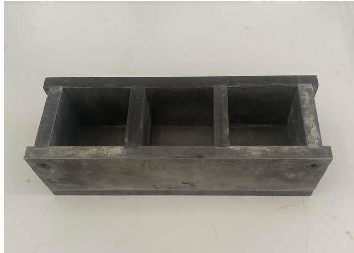
Σχήμα 5.3: Μεταλλικές κυβικές μήτρες χύτευσης
