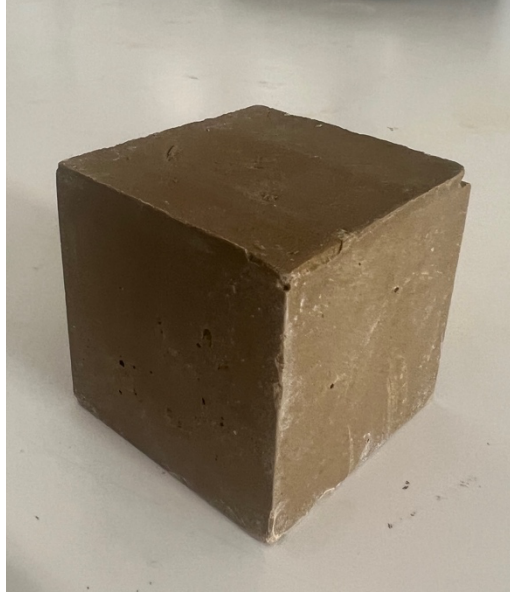
Σχήμα 5.5: Δοκίμιο από 100% αργιλικά στείρα ενδιάμεσα, της εξορυκτικής διαδικασίας (σμεκτίτης με ψηφίδες και χάλικες σερπεντίνη)
