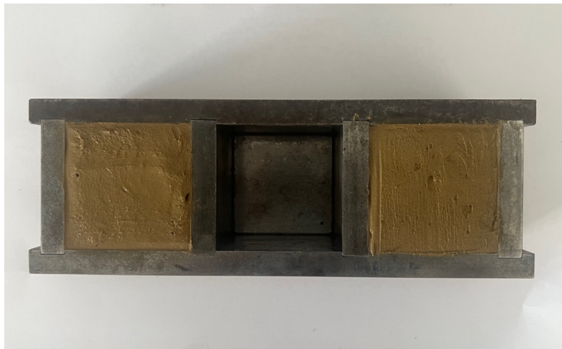
Σχήμα 5.4: Μεταλλικές κυβικές μήτρες χύτευσης με γεωπολυμερικό μίγμα
